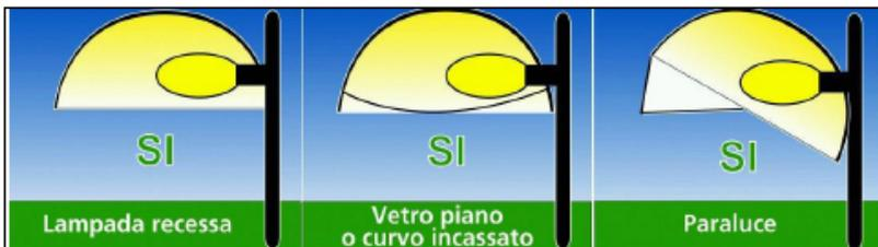
Fig. 2 - Apparecchi conformi alla L.r. 17/09.
