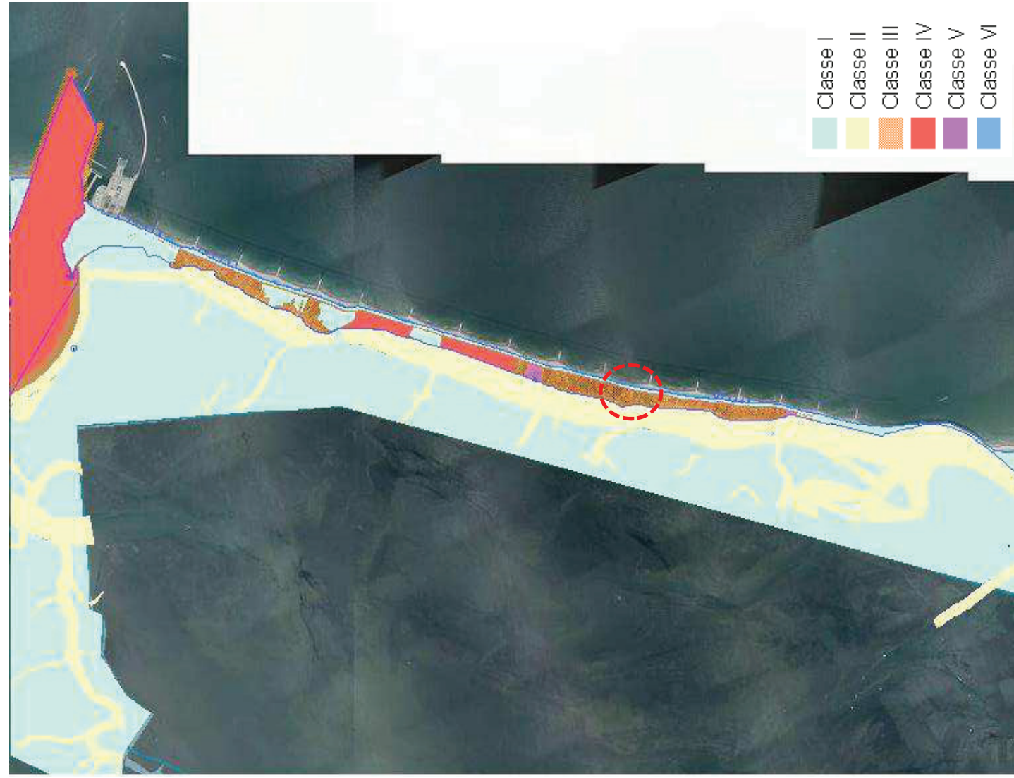
Figura 5-54: Estratto della cartografia del Piano di classificazione acustica del Comune di Venezia (area d'intervento indicata in rosso)
