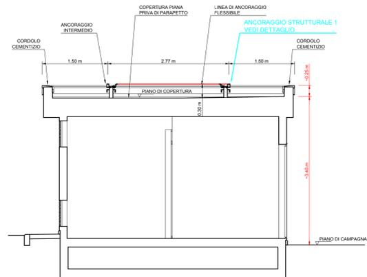
**DETTAGLIO D'INSTALLAZIONE ANCORAGGIO STRUTTURALE 1**
