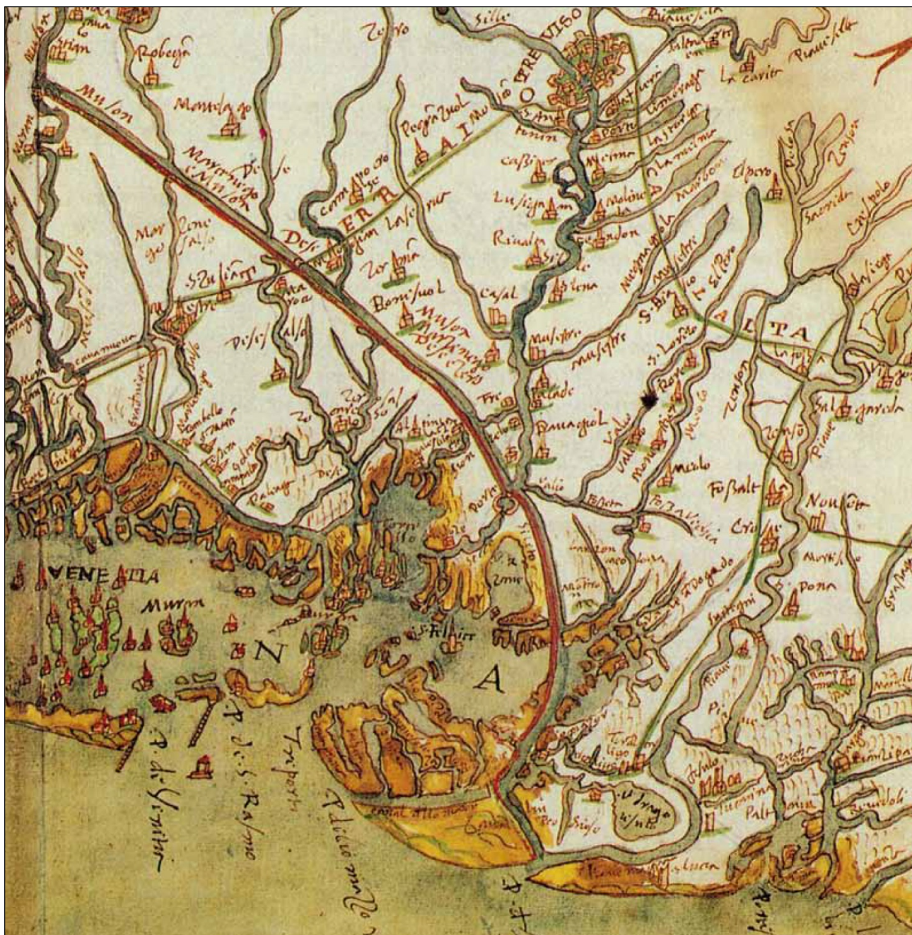
Estratto di una mappa della laguna di Venezia, redatta da Cristoforo Sabbadino nel 1557. Sono illustrati i grandi interventi ipotizzati dal famoso idraulico della Serenissima per distogliere i fiumi dalla laguna superiore e salvaguardarla dai processi di impaludamento. Un canale, che scorre a ridosso dell'argine di guardia, evidenziato in rosso, doveva raccogliere e deviare dalla laguna, oltre alle acque del Sile, quelle di altri fiumi, tra i quali il Muson, il Marzenego, lo Zero e il Dese, per portarle insieme al mare alla foce di Lido Maggiore, attraverso un ultimo tratto di percorso lagunare entro l'omonimo canale. 8
