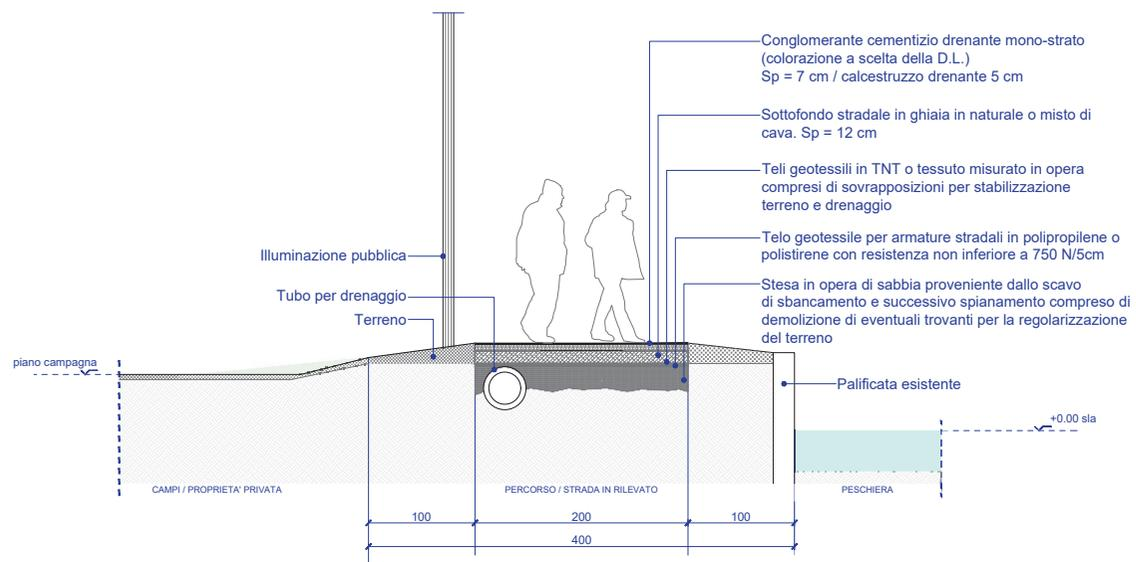
SEZIONE TIPO B - PERCORSO INTERPODERALE CON PALIFICATA ESISTENTE- scala 1:50
