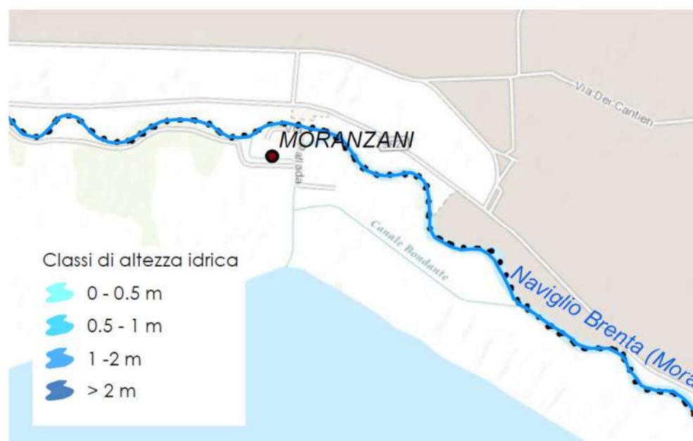
Figura 2.2 – Lo scenario di pericolosità idraulica a bassa probabilità (TR 300 anni) del PGRA del distretto idrografico Alpi Orientali in prossimità della proprietà Centro Nautico Fusina (cfr. tavola P08-HLP-WH)
