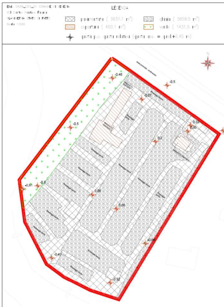
Figura 6.1 – Le superfici impermeabili della proprietà Centro Nautico Fusina allo SDF
