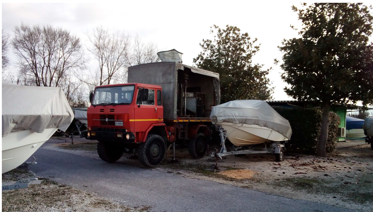
Figura 10: foto del penetrometro posizionato in un punto di prova CPT1 (Manufatto A)
