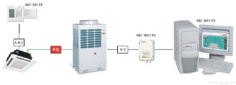
Figura 5 – Gestione di un impianto VRF/VRV
