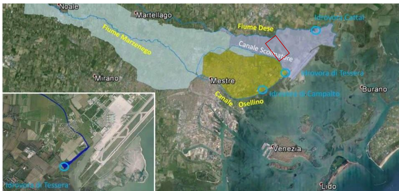
Figura 5-54: Il bacino a scolo alternato del Canale Scolmatore (in azzurro), afferente all'idrovora di Tessera, tra i bacini Cattal (in violetto) e di Campalto (in giallo). Elaborazione in ambiente Google Earth con sfondo foto da satellite 2014.
