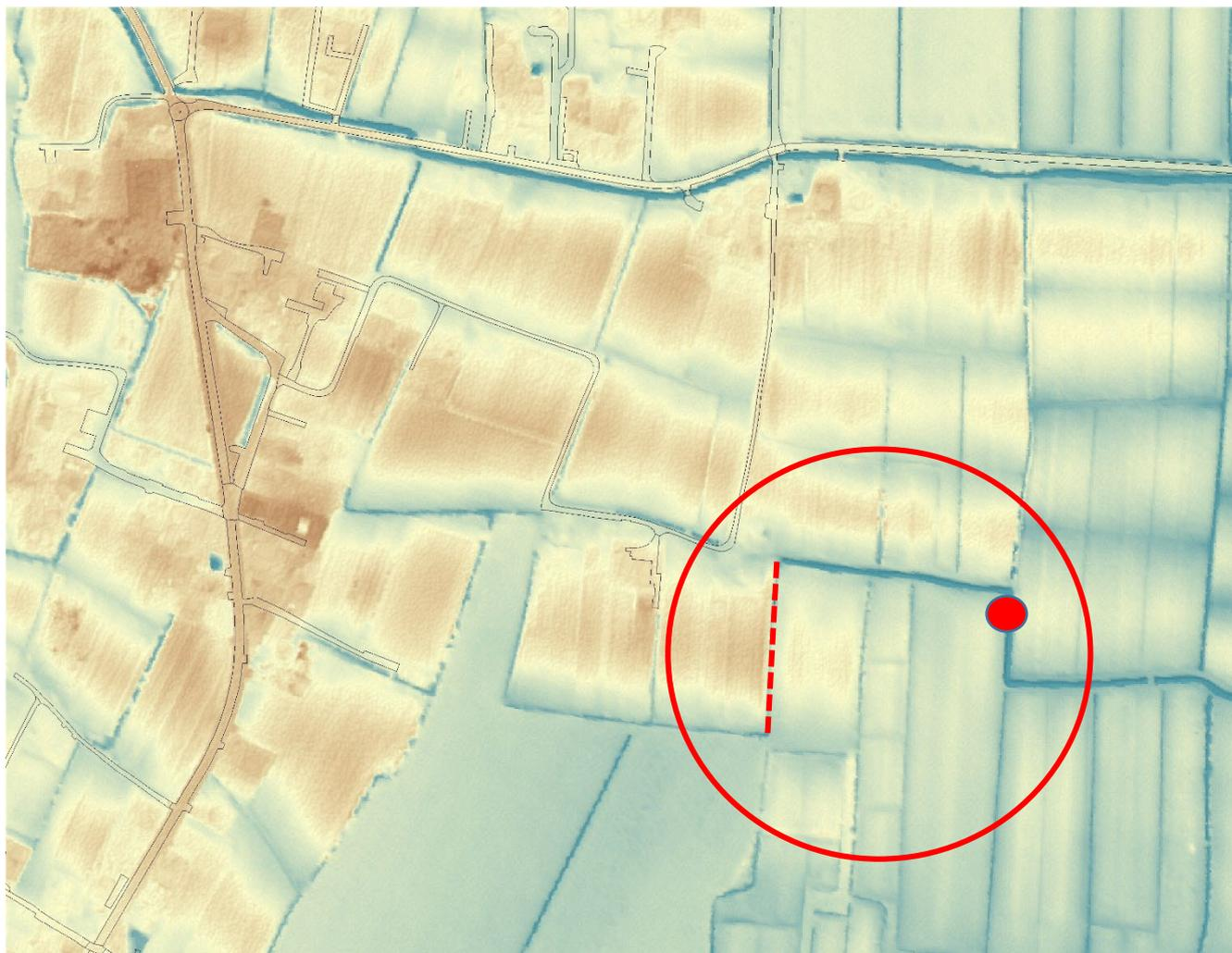
Figura 3 – Inquadramento dell'area di intervento sull'estratto del modello digitale del terreno LiDAR. La linea tratteggiata indica il tratto di collettore da risezionare, il cerchietto rosso indica il manufatto di sostegno.
