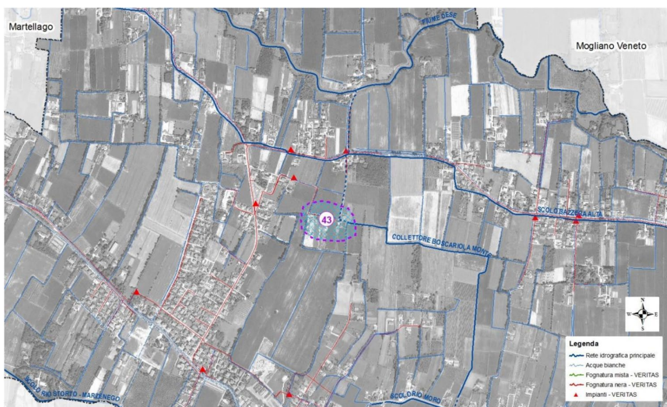
Figura 123 – Estratto del Piano delle Acque del Comune di Venezia. Nella mappa è evidenziata la criticità idraulica n. 43, che interessa via Eraclito e che il presente intervento si propone di mitigare.
