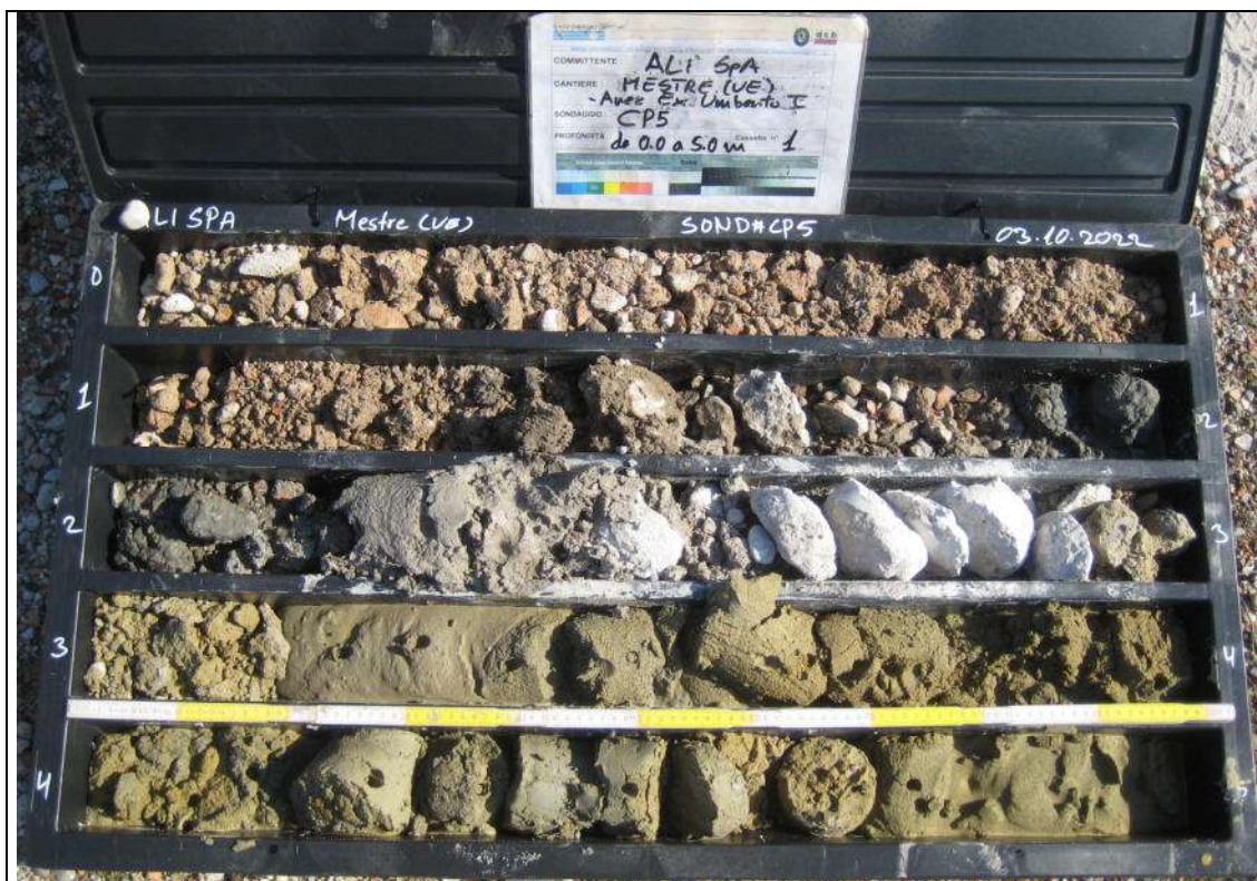
Sondaggio Ambientale CP5 - Contenuto cassetta catalogatrice (0,00 – 5,00 m)
