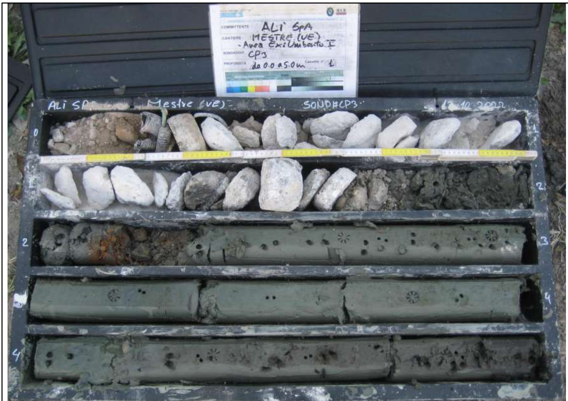
Sondaggio Ambientale CP3 - Contenuto cassetta catalogatrice (0,00 – 5,00 m)
