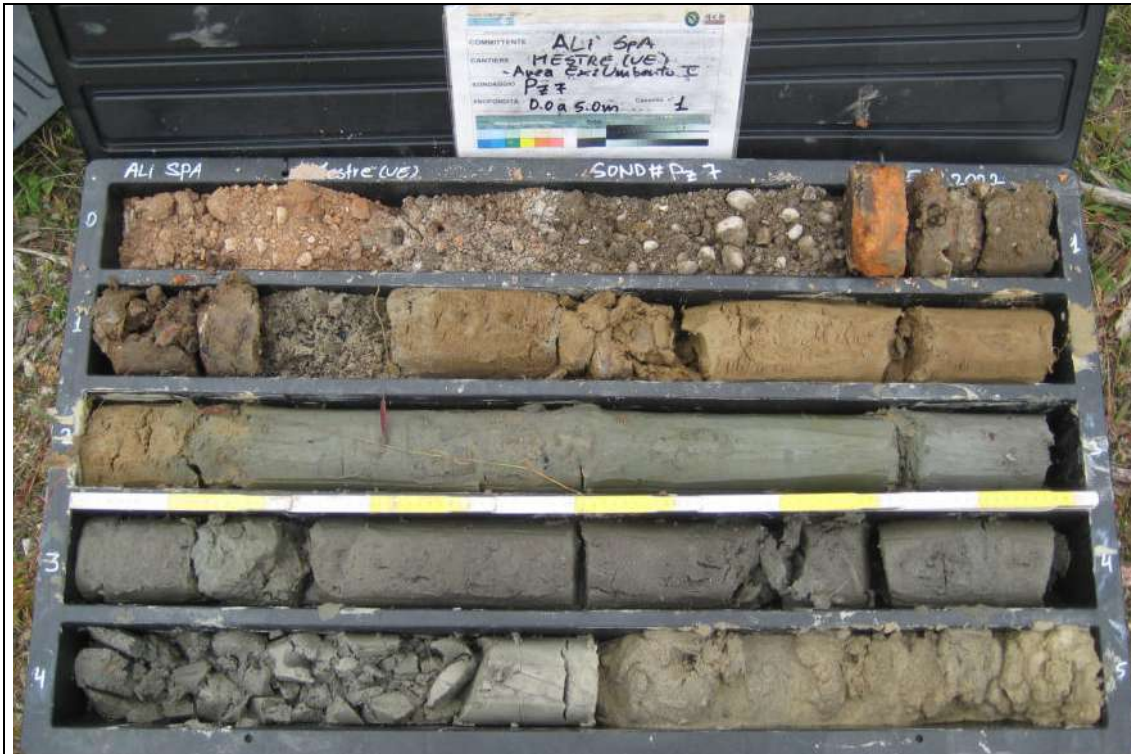
Sondaggio Ambientale Pz7 - Contenuto cassetta catalogatrice (0,00 – 5,00 m)
