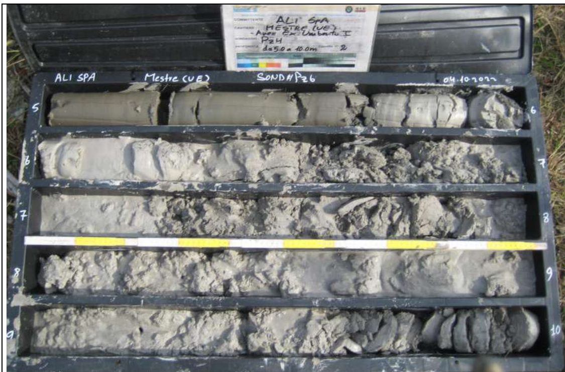
Sondaggio Ambientale Pz4 - Contenuto cassetta catalogatrice (5,00 – 10,00 m)
