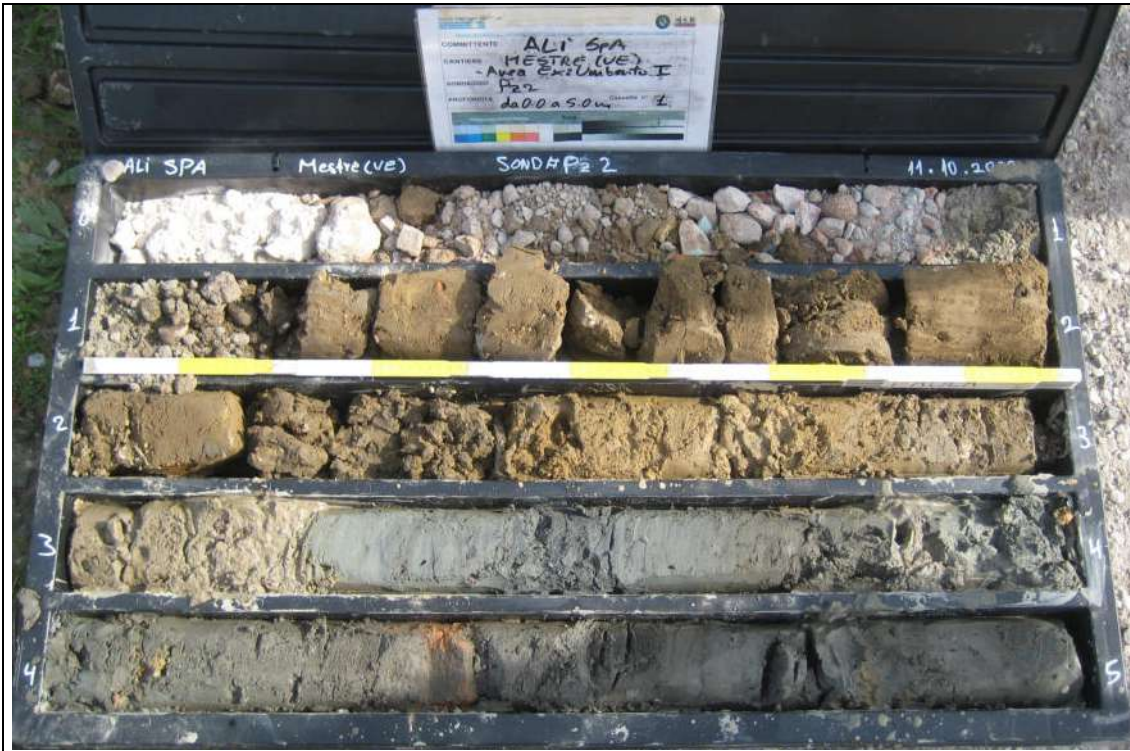
Sondaggio Ambientale Pz2 - Contenuto cassetta catalogatrice (0,00 – 5,00 m)
