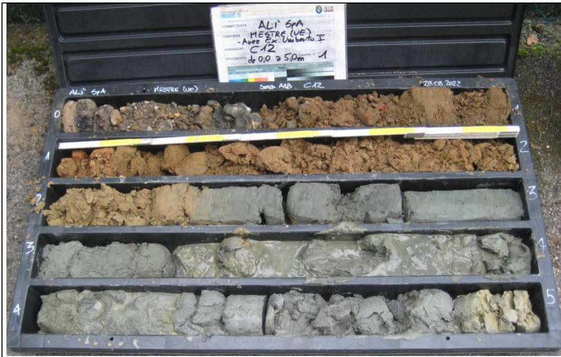
Sondaggio Ambientale C12 - Contenuto cassetta catalogatrice (0,00 – 5,00 m)
