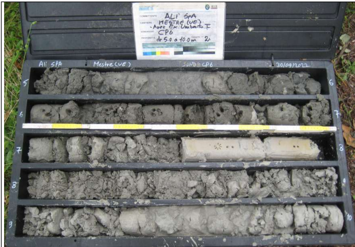
Sondaggio Ambientale CP6 - Contenuto cassetta catalogatrice (5,00 – 10,00 m)
