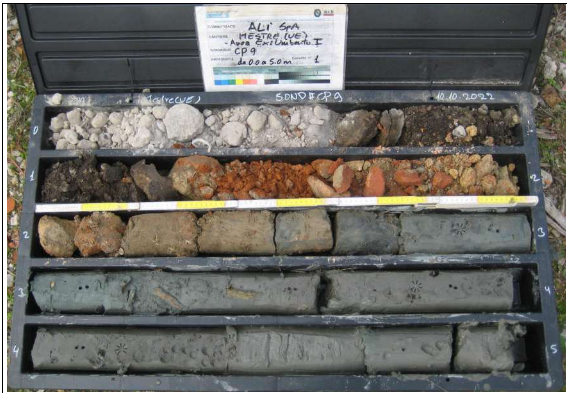
Sondaggio Ambientale CP9 - Contenuto cassetta catalogatrice (0,00 – 5,00 m)
