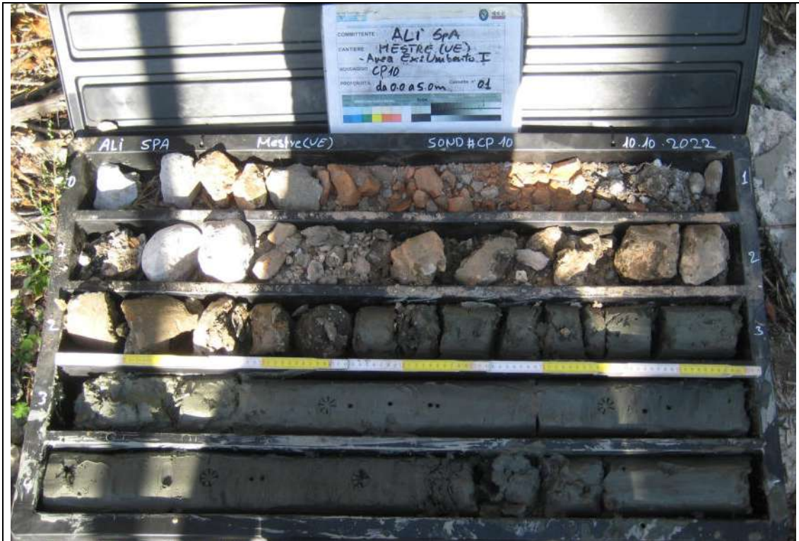
Sondaggio Ambientale CP10 - Contenuto cassetta catalogatrice (0,00 – 5,00 m)
