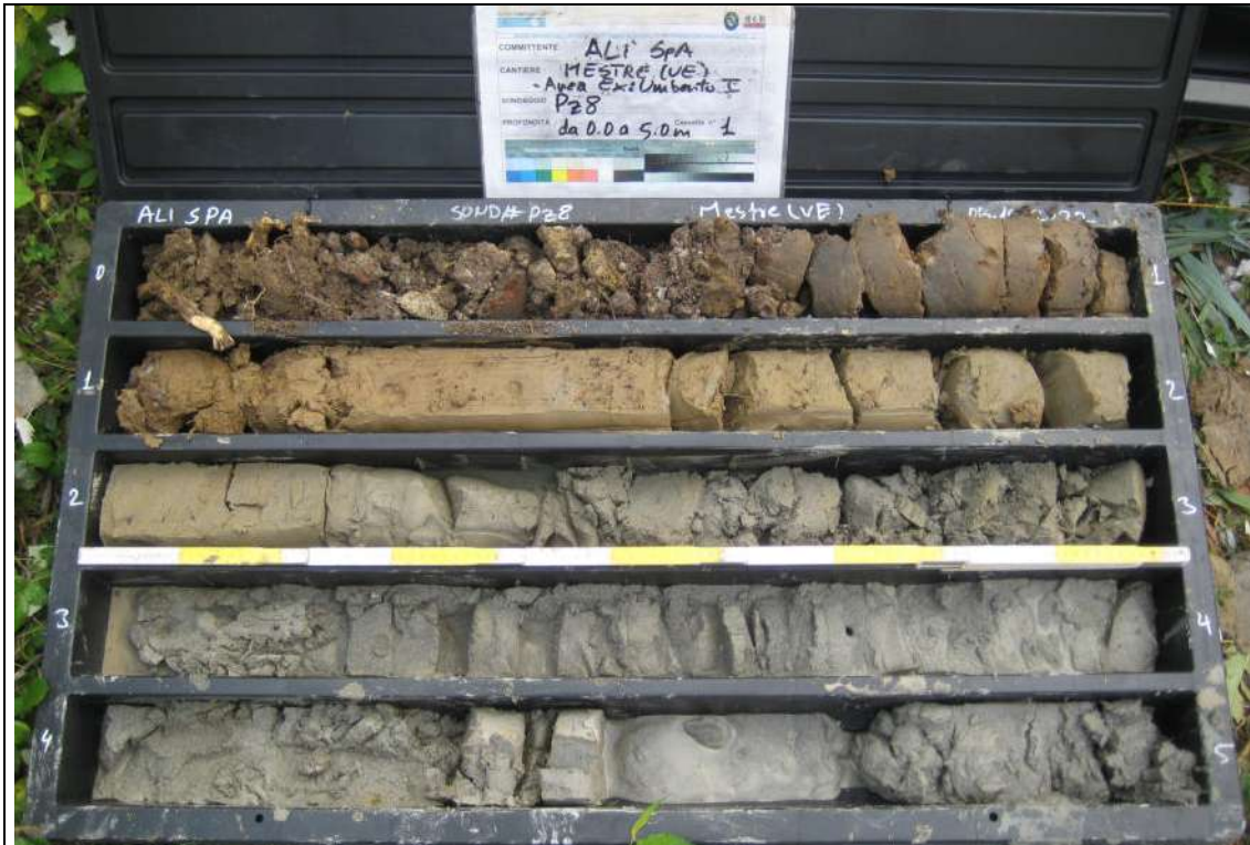
Sondaggio Ambientale Pz8 - Contenuto cassetta catalogatrice (0,00 – 5,00 m)
