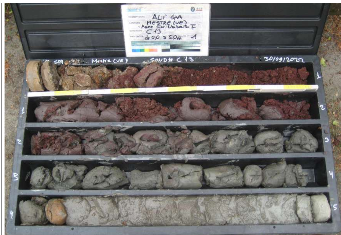
Sondaggio Ambientale C13 - Contenuto cassetta catalogatrice (0,00 – 5,00 m)
