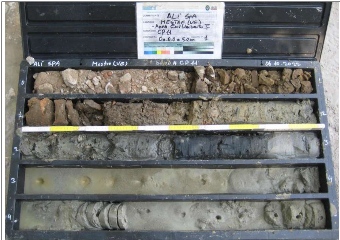
Sondaggio Ambientale CP11 - Contenuto cassetta catalogatrice (0,00 – 5,00 m)
