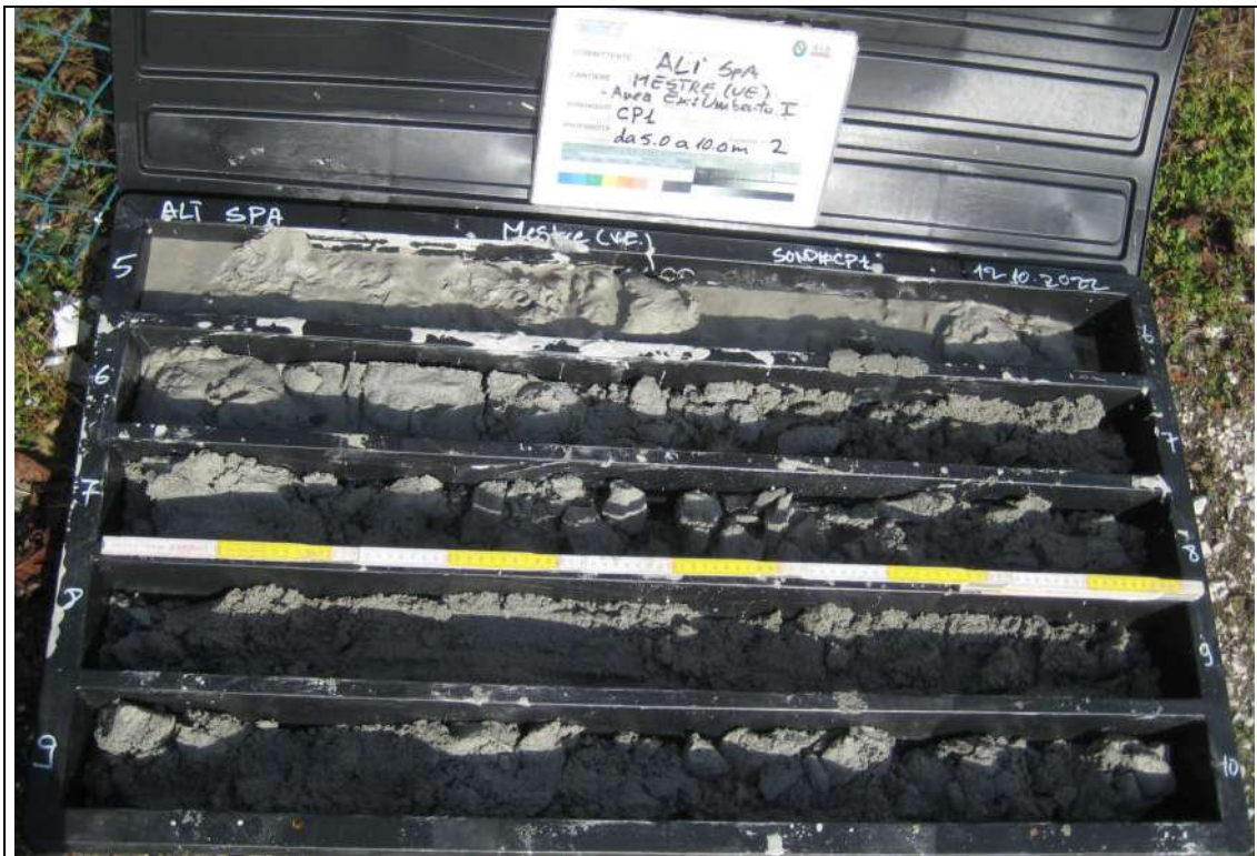
Sondaggio Ambientale CP1 - Contenuto cassetta catalogatrice (5,00 – 10,00 m)
