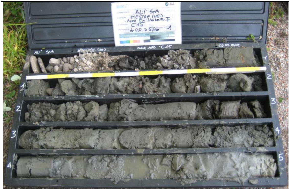
Sondaggio Ambientale C15 - Contenuto cassetta catalogatrice (0,00 – 5,00 m)
