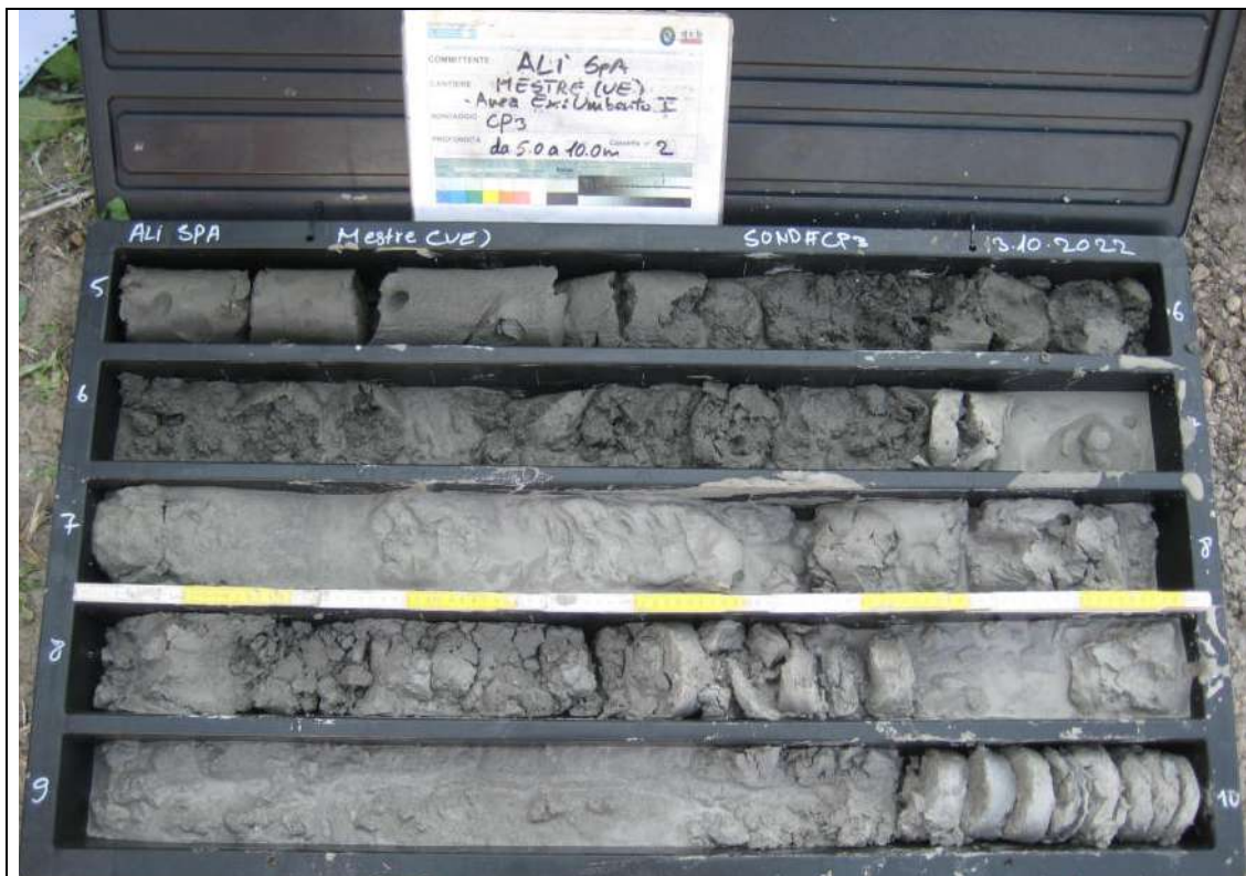
Sondaggio Ambientale CP3 - Contenuto cassetta catalogatrice (5,00 – 10,00 m)
