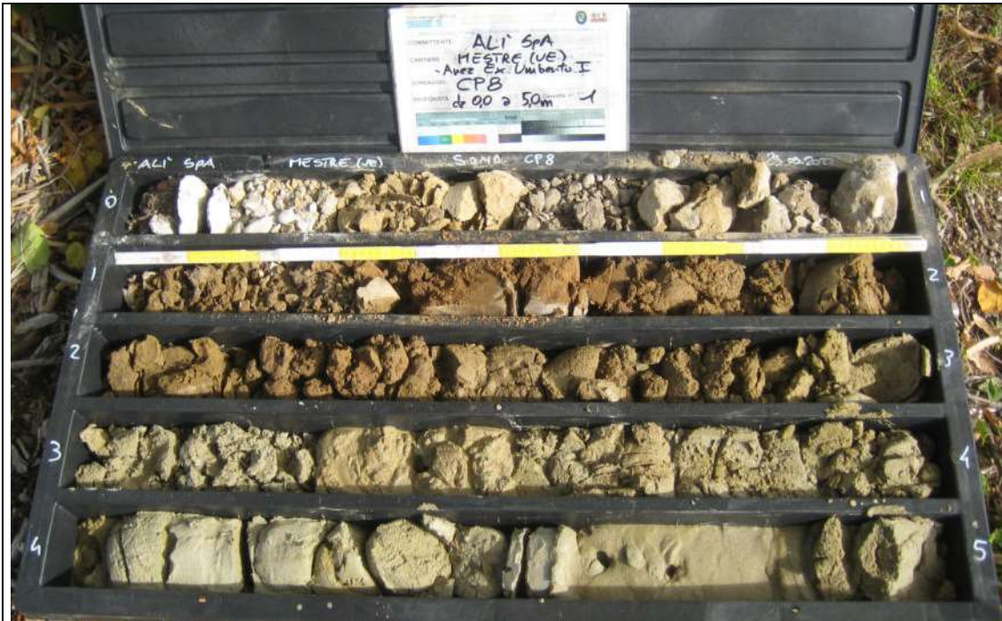
Sondaggio Ambientale CP8 - Contenuto cassetta catalogatrice (0,00 – 5,00 m)
