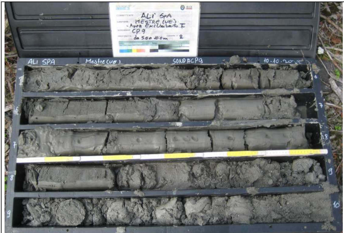
Sondaggio Ambientale CP9 - Contenuto cassetta catalogatrice (5,00 – 10,00 m)
