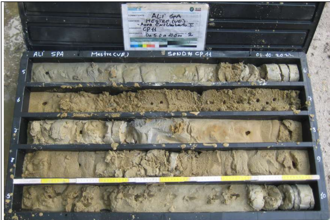
Sondaggio Ambientale CP11 - Contenuto cassetta catalogatrice (5,00 – 10,00 m)
