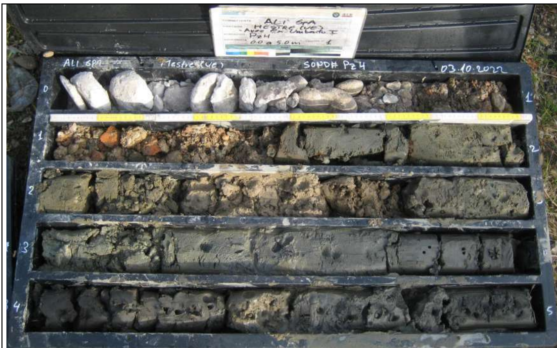
Sondaggio Ambientale Pz4 - Contenuto cassetta catalogatrice (0,00 – 5,00 m)
