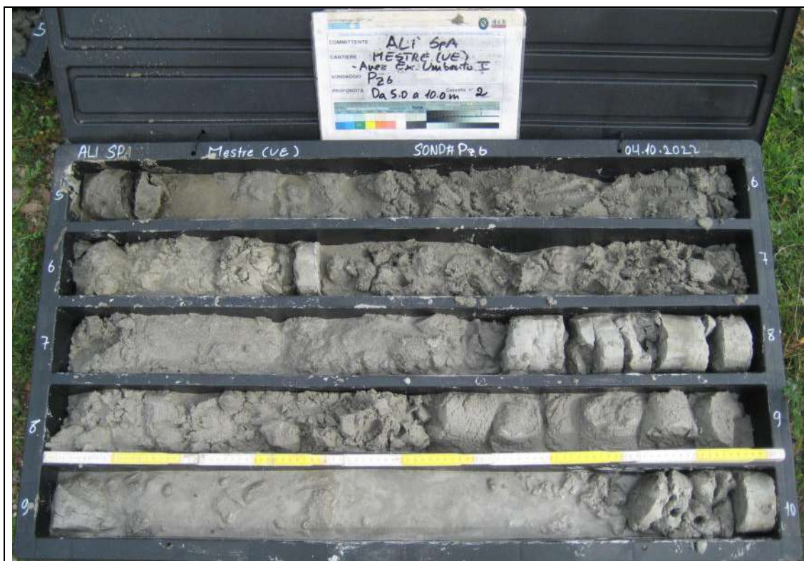
Sondaggio Ambientale Pz6 - Contenuto cassetta catalogatrice (5,00 – 10,00 m)
