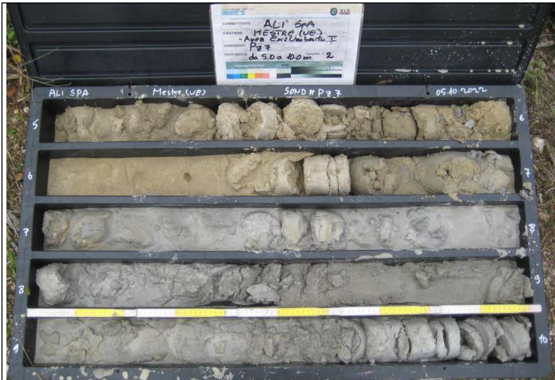
Sondaggio Ambientale Pz7 - Contenuto cassetta catalogatrice (5,00 – 10,00 m)
