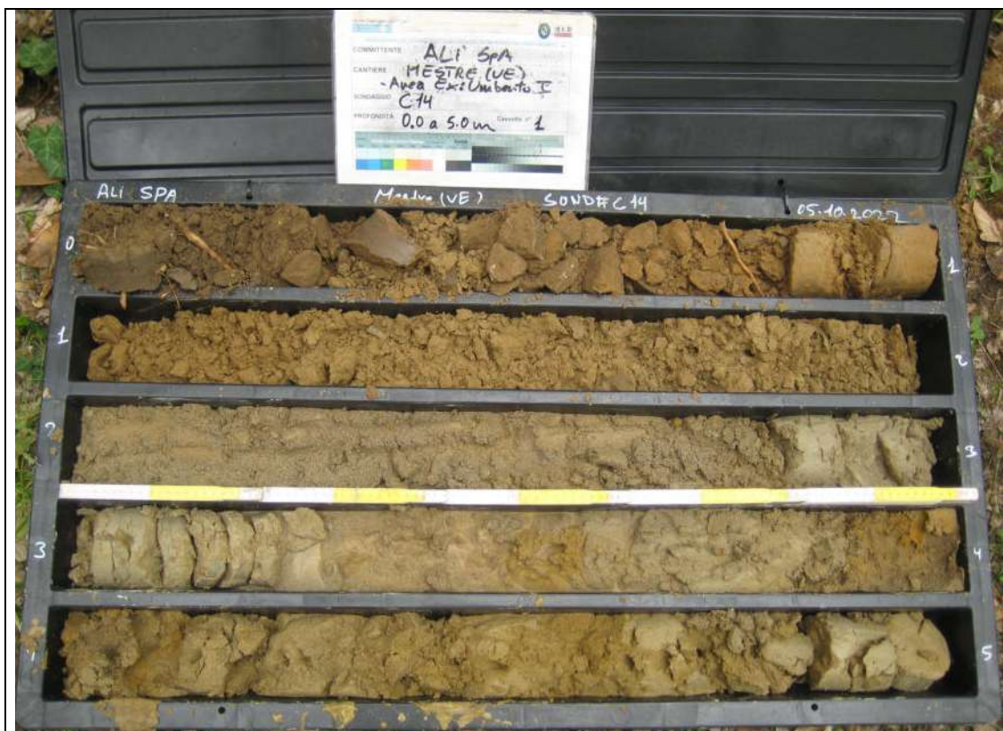
Sondaggio Ambientale C14 - Contenuto cassetta catalogatrice (0,00 – 5,00 m)
