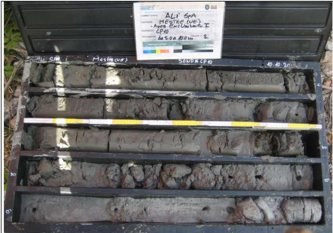
Sondaggio Ambientale CP10 - Contenuto cassetta catalogatrice (5,00 – 10,00 m)
