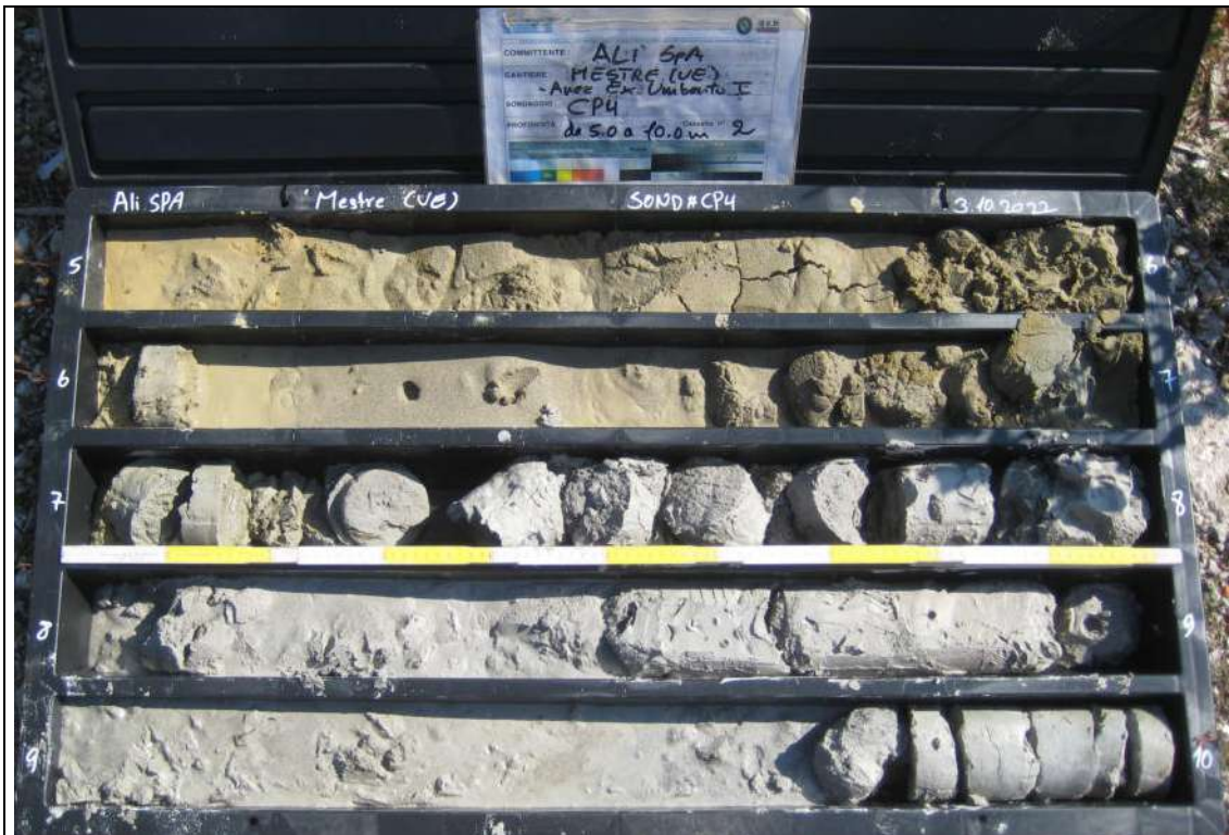
Sondaggio Ambientale CP4 - Contenuto cassetta catalogatrice (5,00 – 10,00 m)
