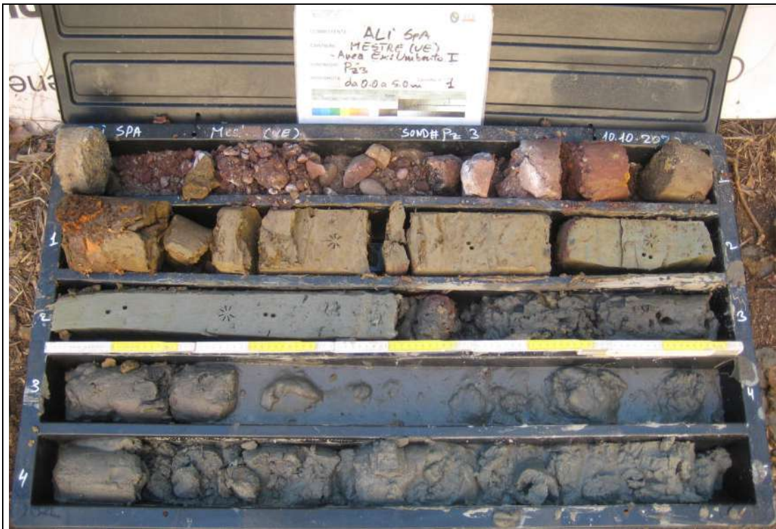
Sondaggio Ambientale Pz3 - Contenuto cassetta catalogatrice (0,00 – 5,00 m)
