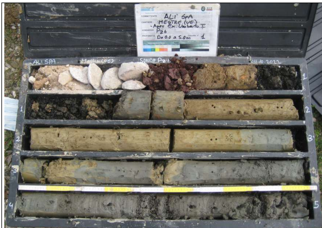
Sondaggio Ambientale Pz6 - Contenuto cassetta catalogatrice (0,00 – 5,00 m)
