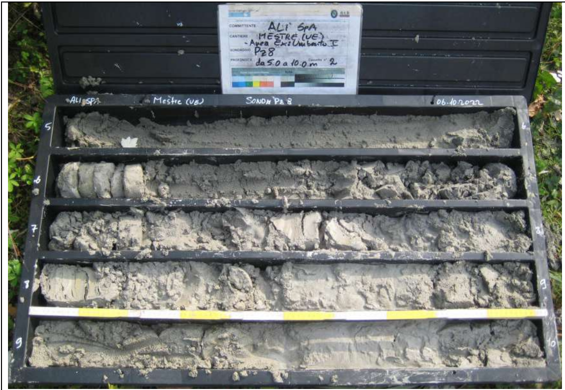
Sondaggio Ambientale Pz8 - Contenuto cassetta catalogatrice (5,00 – 10,00 m)
