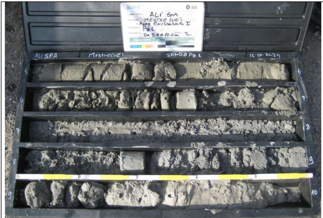
Sondaggio Ambientale Pz1 - Contenuto cassetta catalogatrice (5,00 – 10,00 m)
