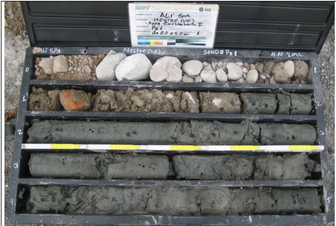
Sondaggio Ambientale Pz1 - Contenuto cassetta catalogatrice (0,00 – 5,00 m)
