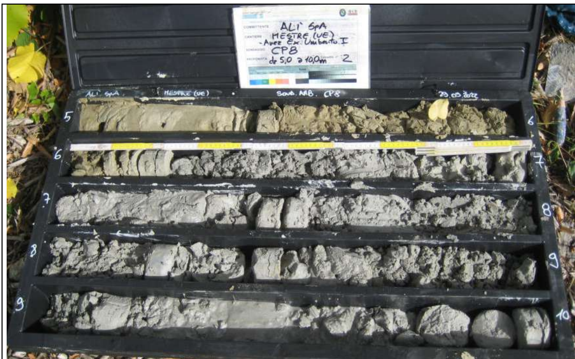
Sondaggio Ambientale CP8 - Contenuto cassetta catalogatrice (5,00 – 10,00 m)
