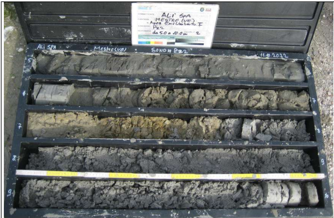
Sondaggio Ambientale Pz2 - Contenuto cassetta catalogatrice (5,00 – 10,00 m)
