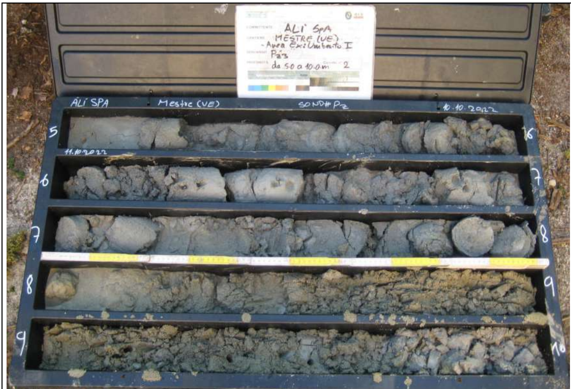
Sondaggio Ambientale Pz3 - Contenuto cassetta catalogatrice (5,00 – 10,00 m)
