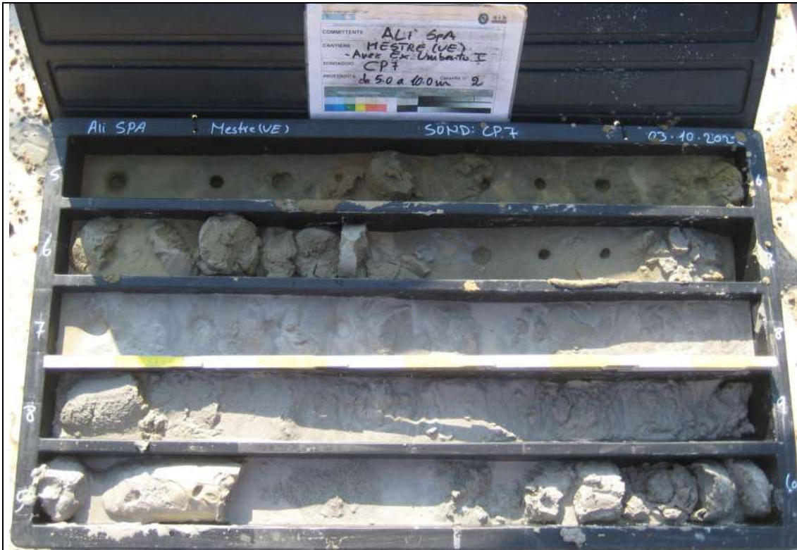
Sondaggio Ambientale CP7 - Contenuto cassetta catalogatrice (5,00 – 10,00 m)
