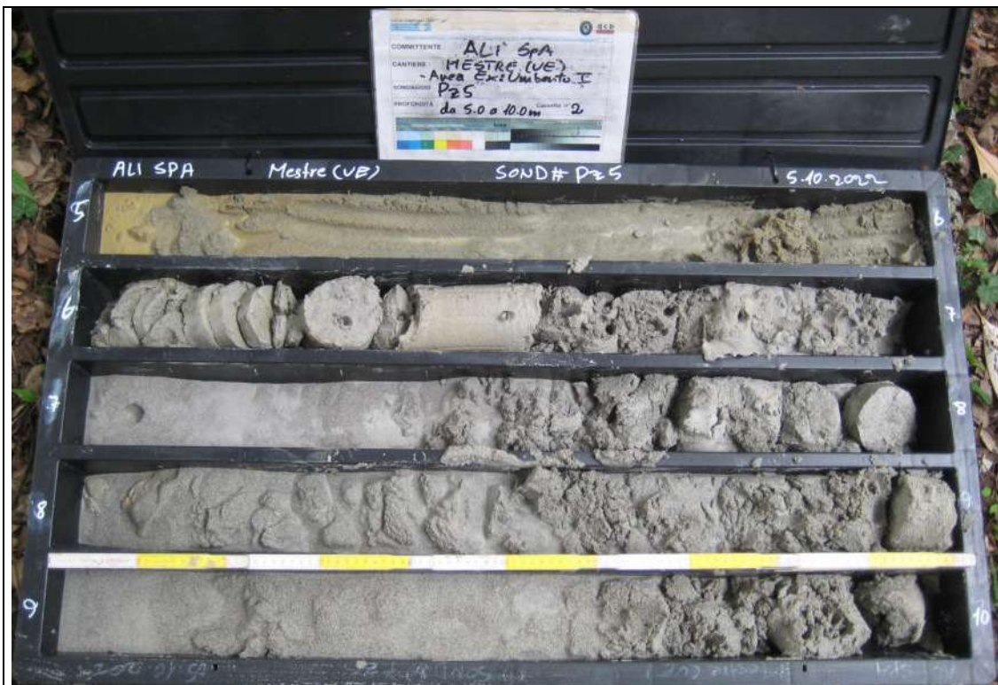
Sondaggio Ambientale Pz5 - Contenuto cassetta catalogatrice (5,00 – 10,00 m)
