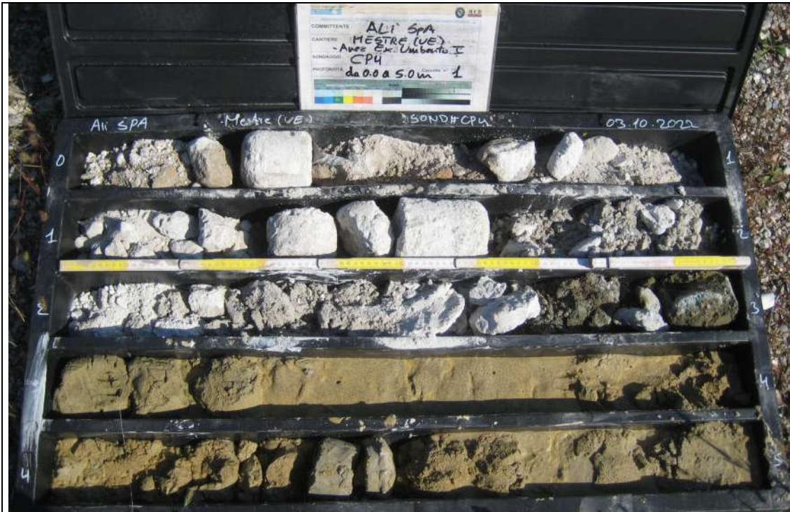
Sondaggio Ambientale CP4 - Contenuto cassetta catalogatrice (0,00 – 5,00 m)
