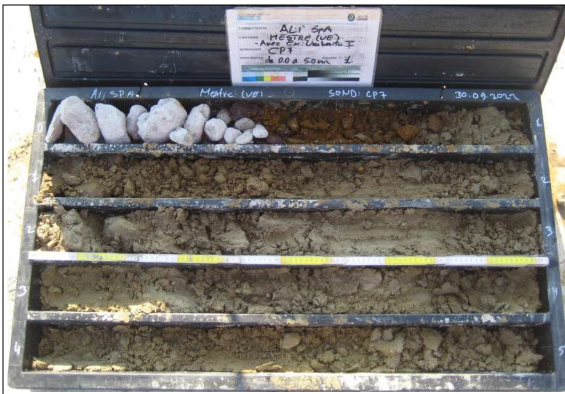
Sondaggio Ambientale CP7 - Contenuto cassetta catalogatrice (0,00 – 5,00 m)
