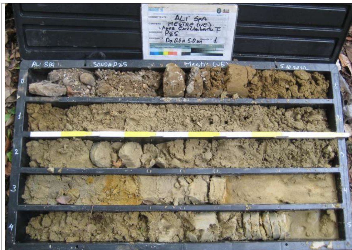
Sondaggio Ambientale Pz5 - Contenuto cassetta catalogatrice (0,00 – 5,00 m)
