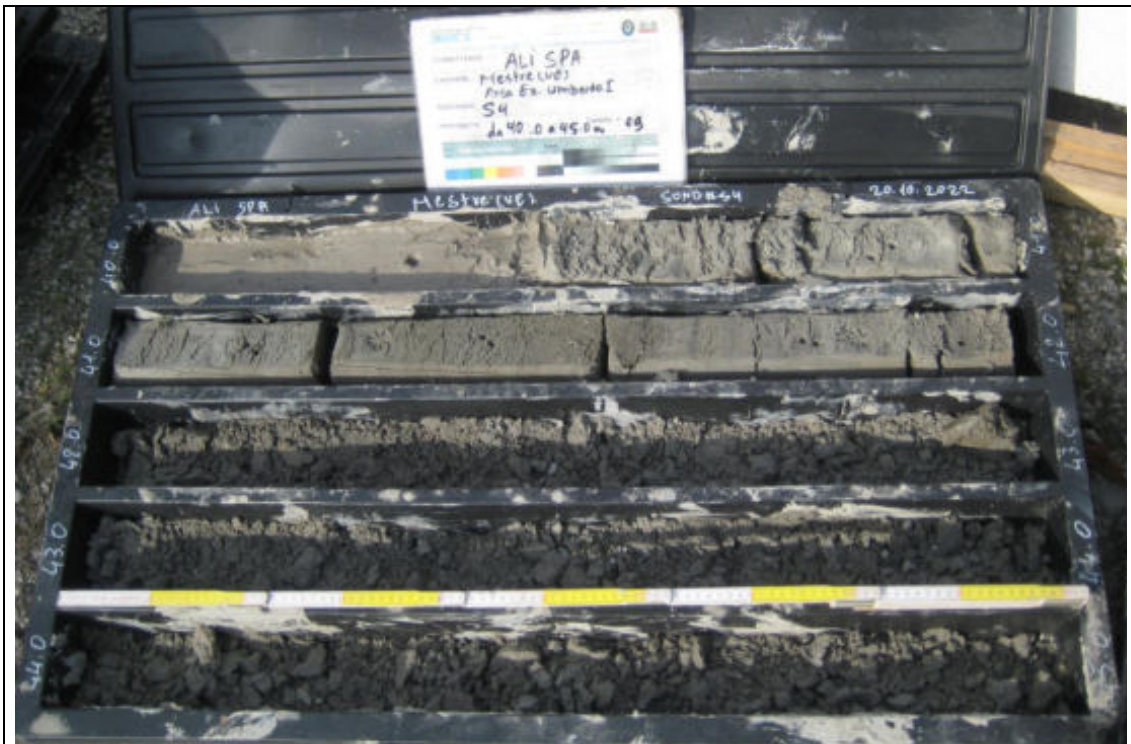
Sondaggio Geognostico S4 - Contenuto cassetta catalogatrice (40,00 – 45,00 m)
