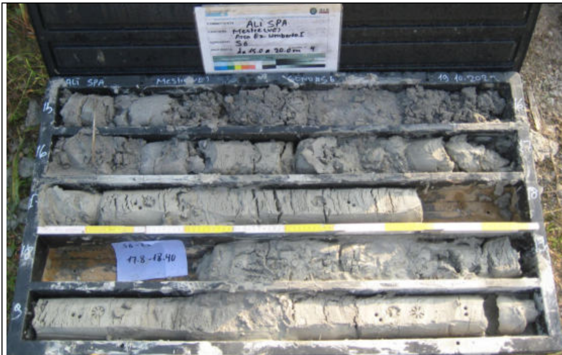
Sondaggio Geognostico S6 - Contenuto cassetta catalogatrice (15,00 – 20,00 m)
