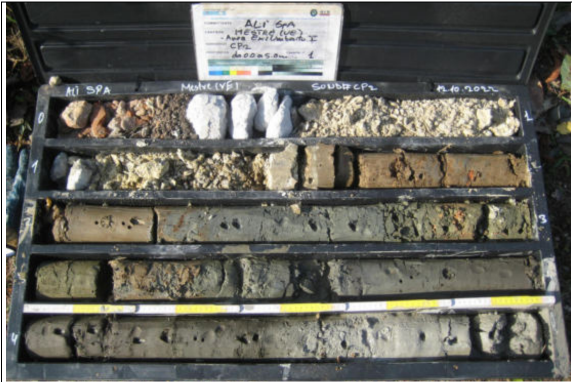
Sondaggio Geognostico S2 - Contenuto cassetta catalogatrice (0,00 – 5,00 m)
