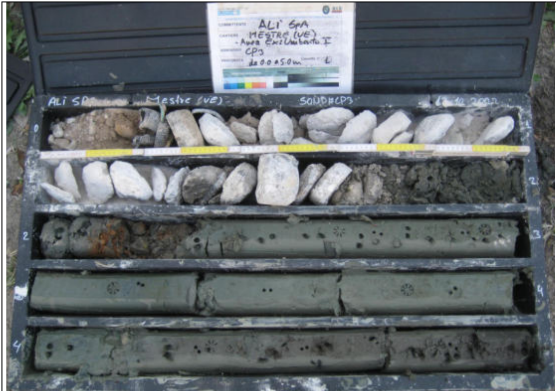
Sondaggio Geognostico S5 - Contenuto cassetta catalogatrice (0,00 – 5,00 m)
