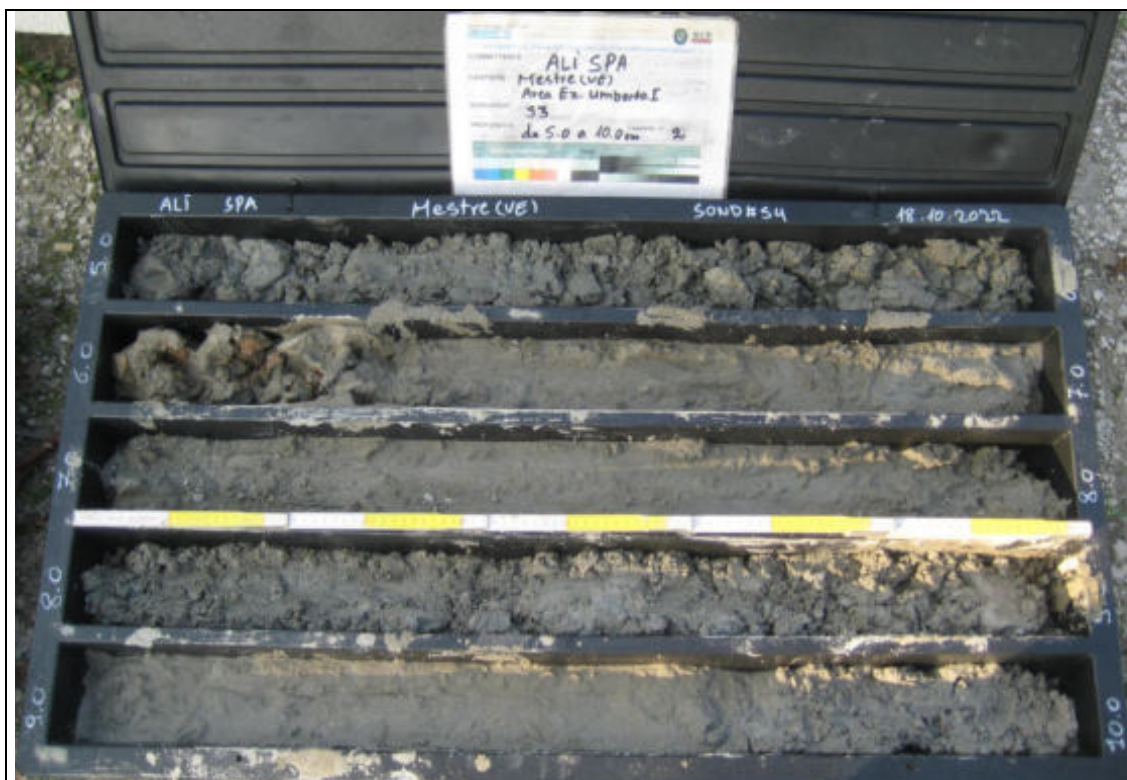
Sondaggio Geognostico S3 - Contenuto cassetta catalogatrice (5,00 – 10,00 m)
