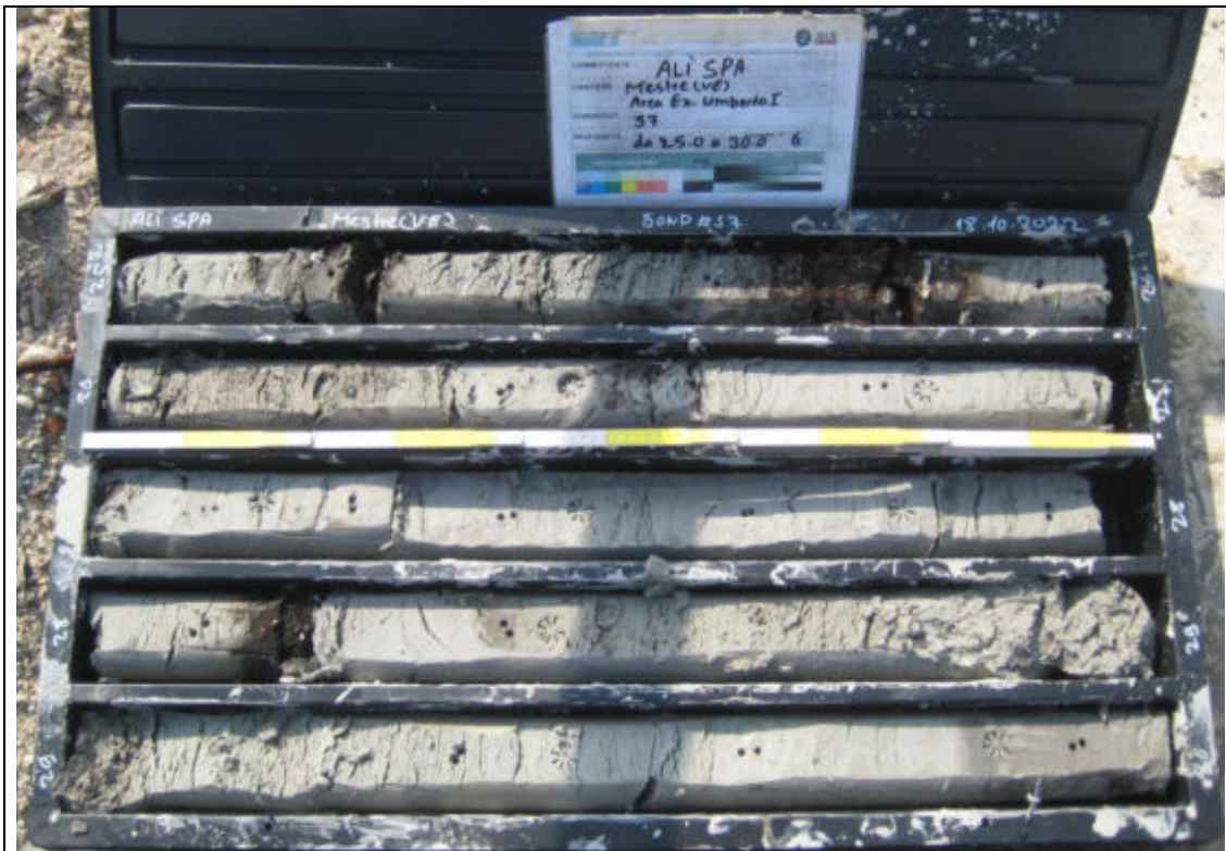
Sondaggio Geognostico S7 - Contenuto cassetta catalogatrice (25,00 – 30,00 m)
