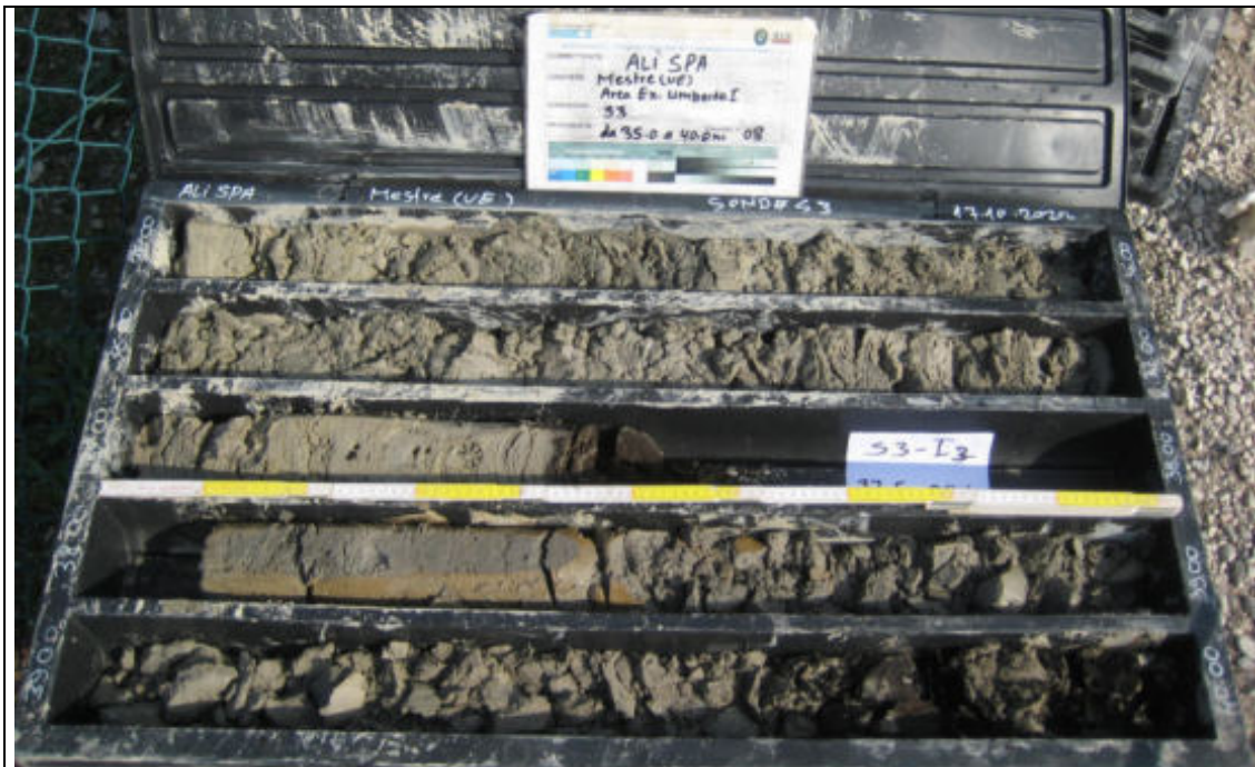
Sondaggio Geognostico S3 - Contenuto cassetta catalogatrice (35,00 – 40,00 m)
