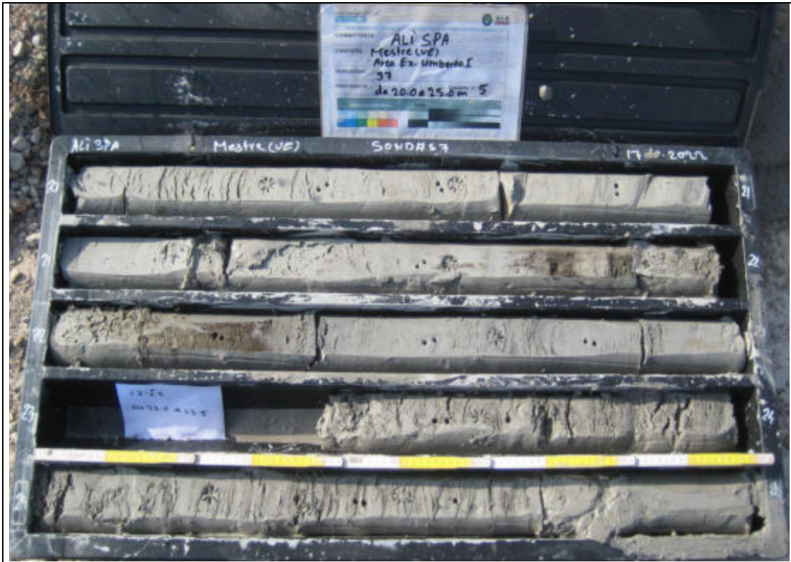
Sondaggio Geognostico S7 - Contenuto cassetta catalogatrice (20,00 – 25,00 m)
