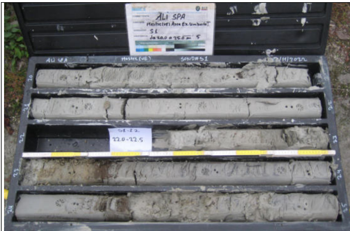
Sondaggio Geognostico S1 - Contenuto cassetta catalogatrice (20,00 – 25,00 m)
