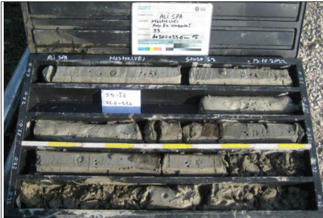
Sondaggio Geognostico S3 - Contenuto cassetta catalogatrice (20,00 – 25,00 m)
