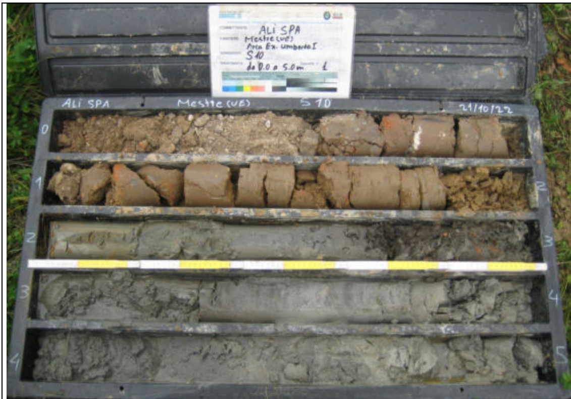
Sondaggio Geognostico S10 - Contenuto cassetta catalogatrice (0,00 – 5,00 m)
