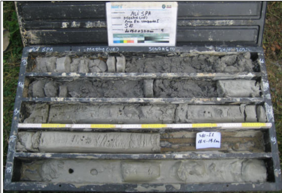
Sondaggio Geognostico S10 - Contenuto cassetta catalogatrice (15,00 – 20,00 m)
