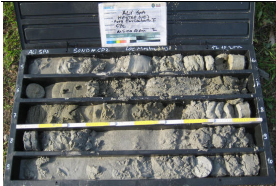
Sondaggio Geognostico S2 - Contenuto cassetta catalogatrice (5,00 – 10,00 m)
