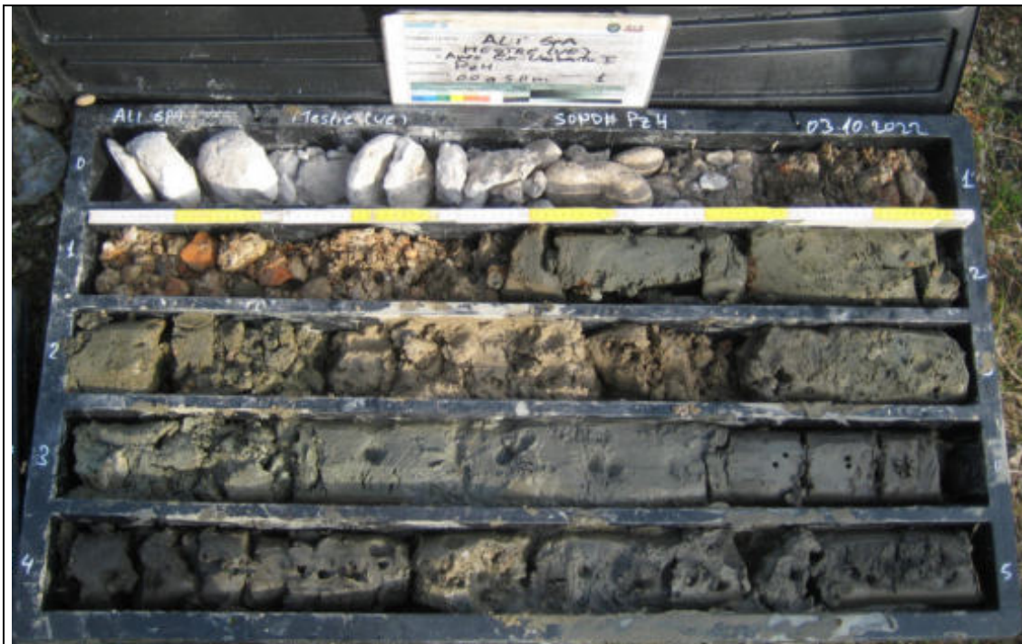
Sondaggio Geognostico S6 - Contenuto cassetta catalogatrice (0,00 – 5,00 m)
