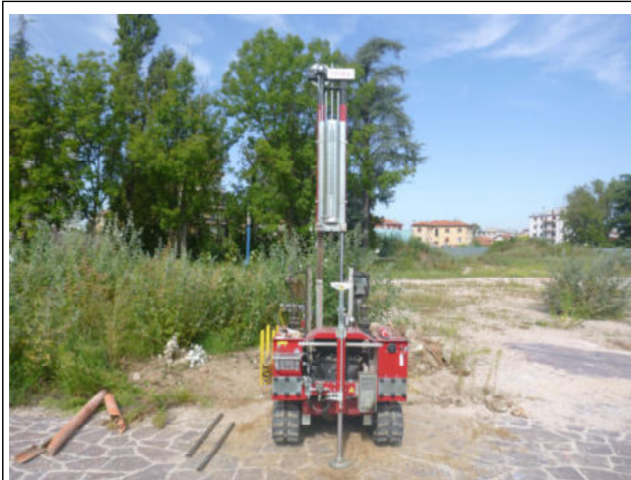
Foto 1: Esecuzione della prova CPTU1
