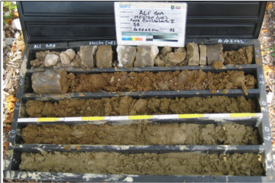
Sondaggio Geognostico S9 - Contenuto cassetta catalogatrice (0,00 – 5,00 m)
