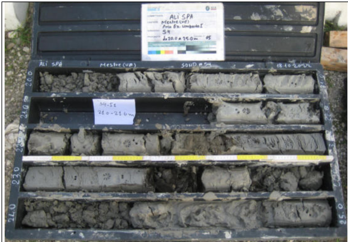
Sondaggio Geognostico S4 - Contenuto cassetta catalogatrice (20,00 – 25,00 m)
