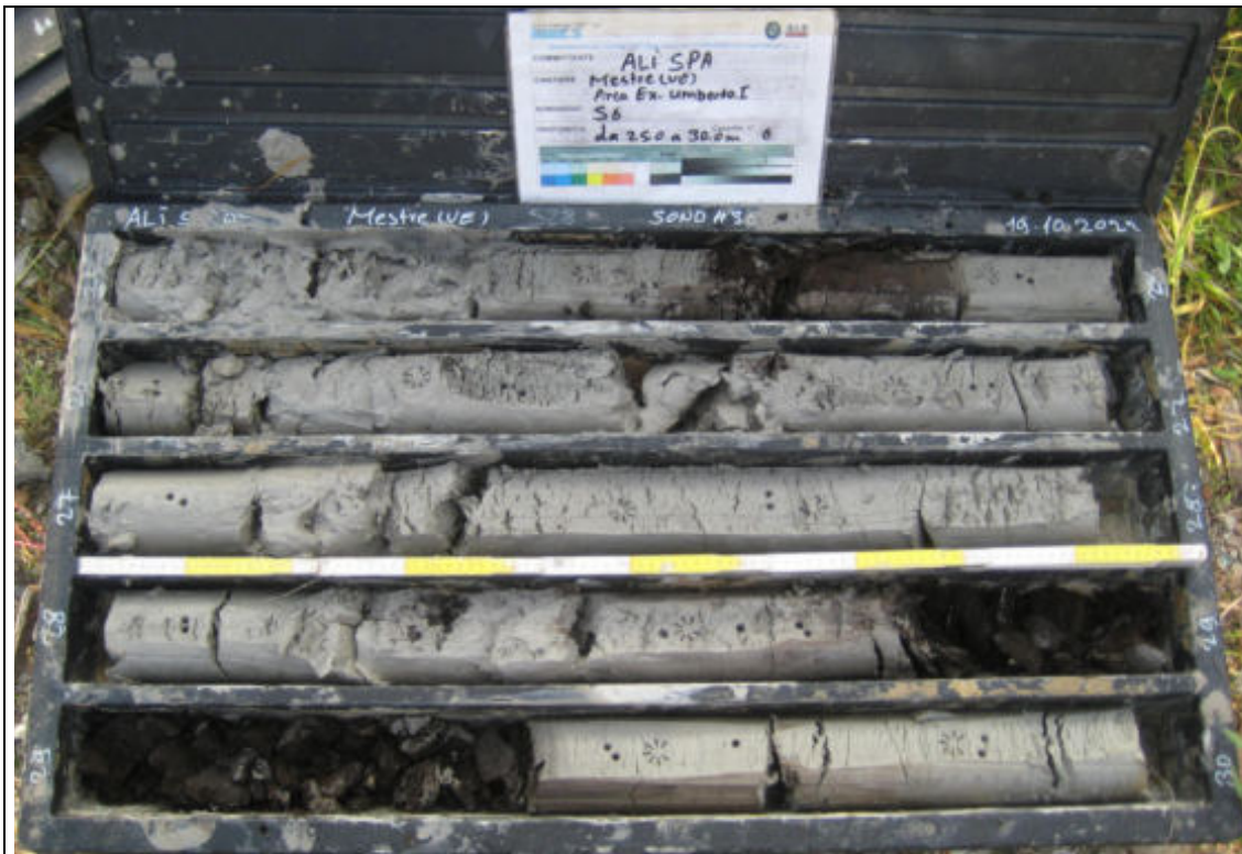
Sondaggio Geognostico S6 - Contenuto cassetta catalogatrice (25,00 – 30,00 m)
