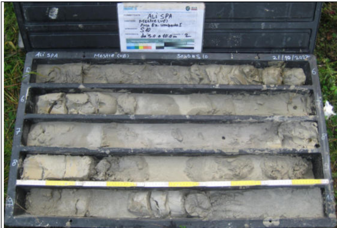
Sondaggio Geognostico S10 - Contenuto cassetta catalogatrice (5,00 – 10,00 m)
