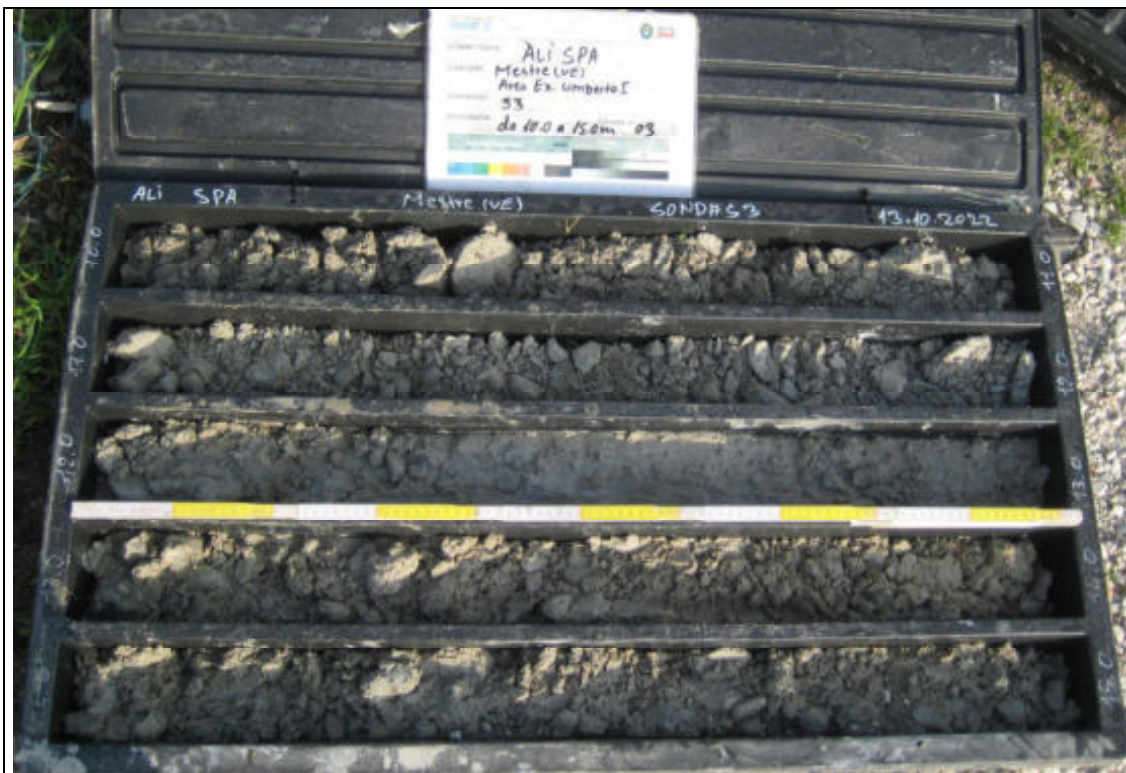
Sondaggio Geognostico S3 - Contenuto cassetta catalogatrice (10,00 – 15,00 m)
