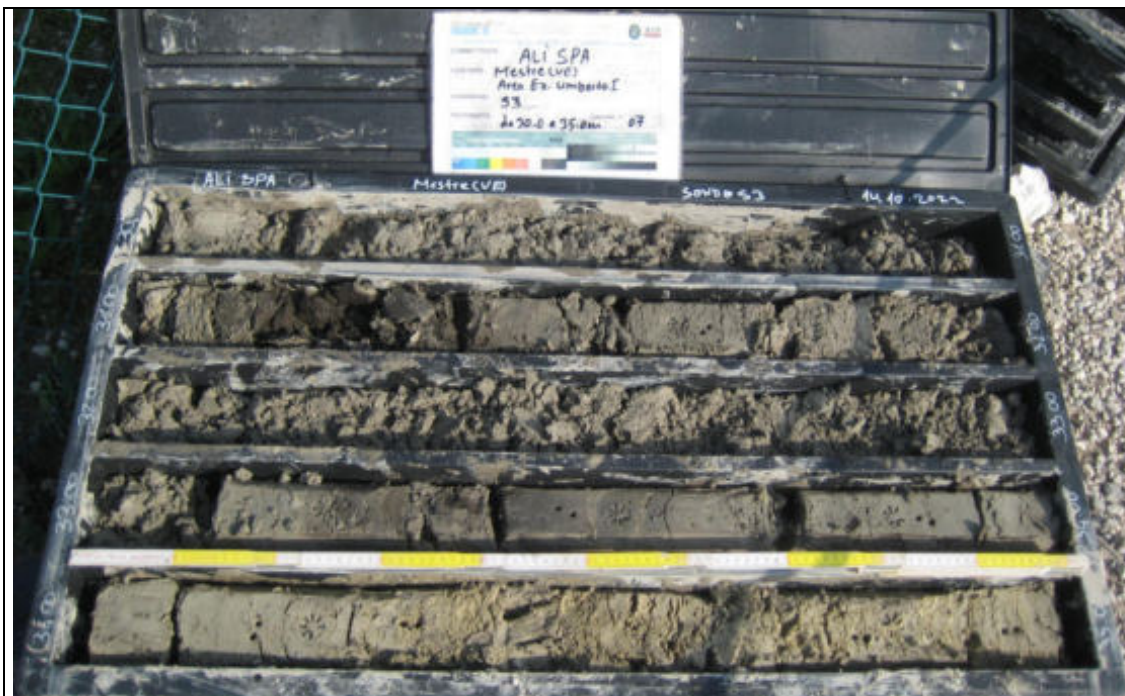
Sondaggio Geognostico S3 - Contenuto cassetta catalogatrice (30,00 – 35,00 m)
