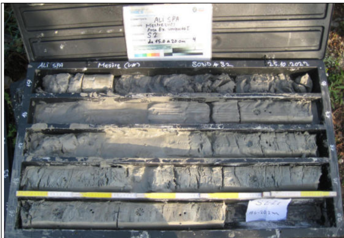
Sondaggio Geognostico S2 - Contenuto cassetta catalogatrice (15,00 – 20,00 m)
