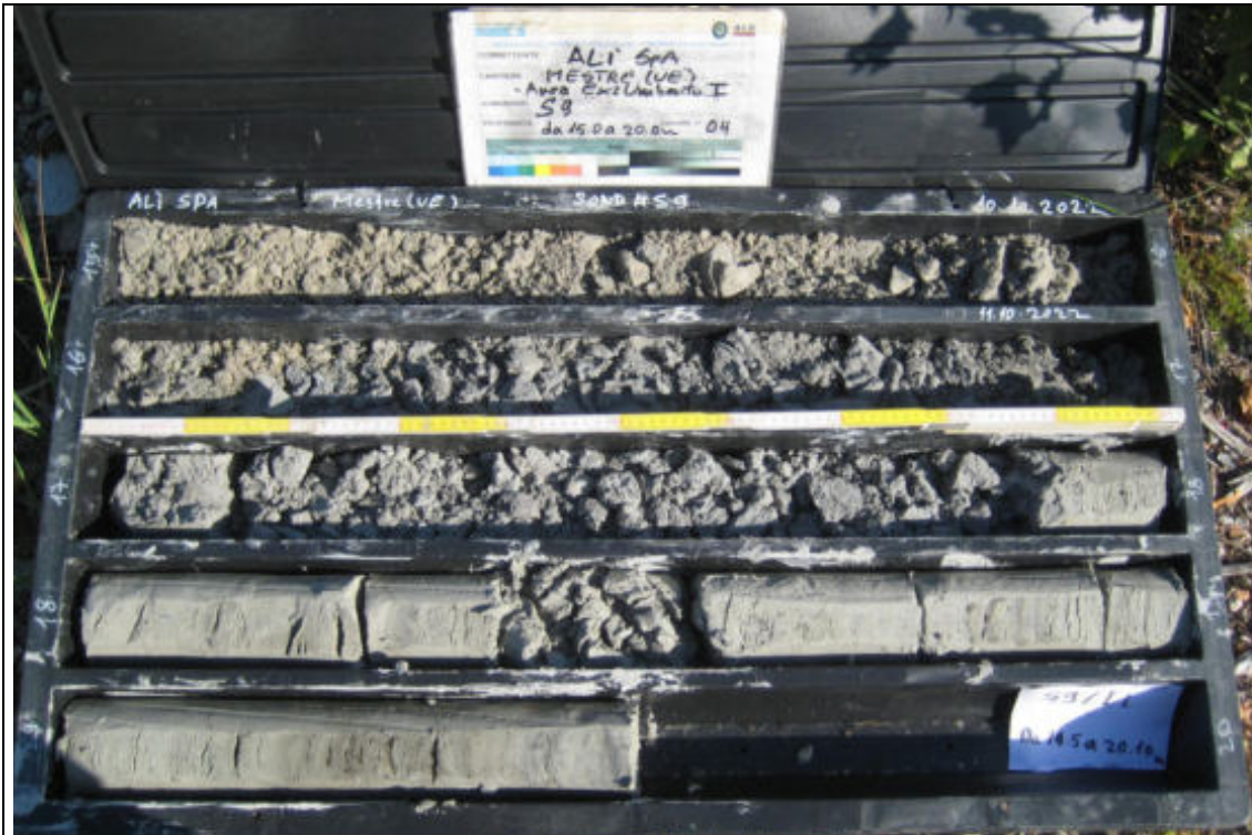
Sondaggio Geognostico S9 - Contenuto cassetta catalogatrice (15,00 – 20,00 m)
