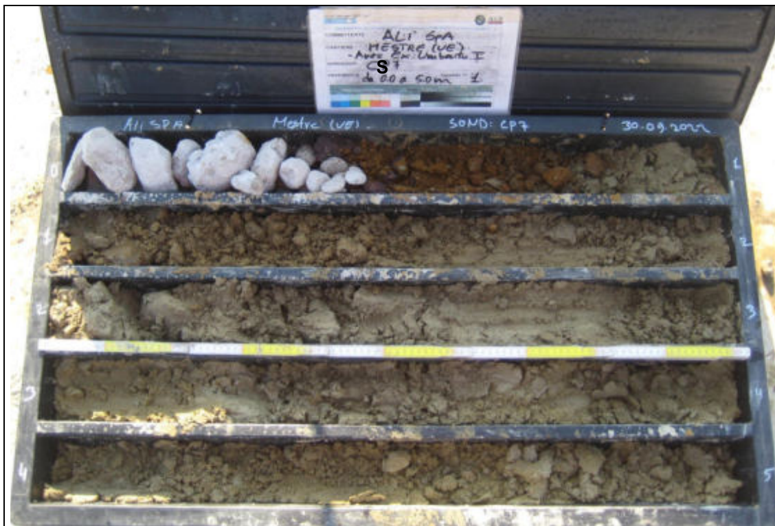
Sondaggio Geognostico S7 - Contenuto cassetta catalogatrice (0,00 – 5,00 m)
