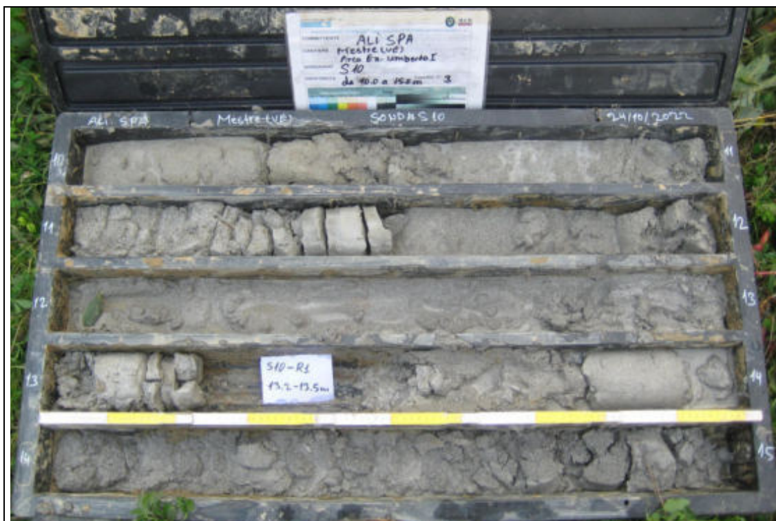
Sondaggio Geognostico S10 - Contenuto cassetta catalogatrice (10,00 – 15,00 m)
