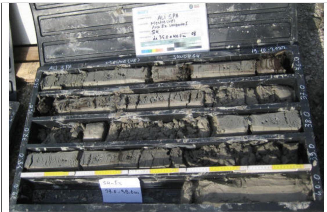
Sondaggio Geognostico S4 - Contenuto cassetta catalogatrice (35,00 – 40,00 m)
