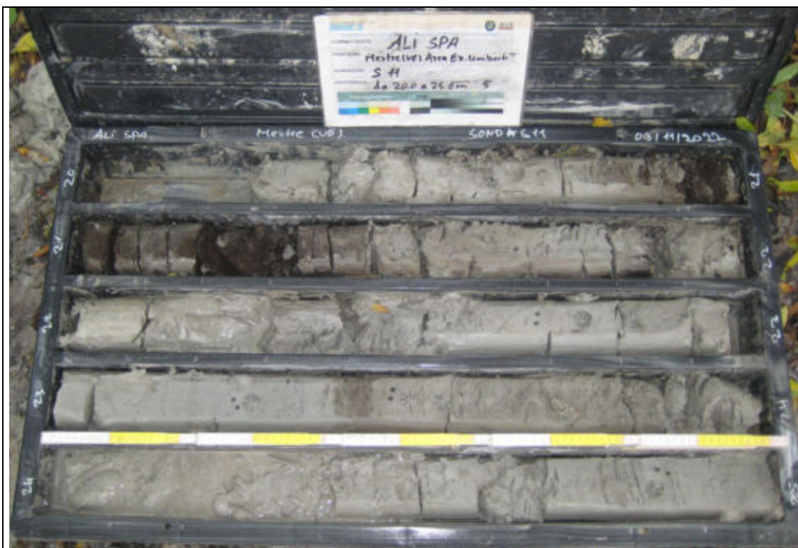
Sondaggio Geognostico S11 - Contenuto cassetta catalogatrice (20,00 – 25,00 m)
