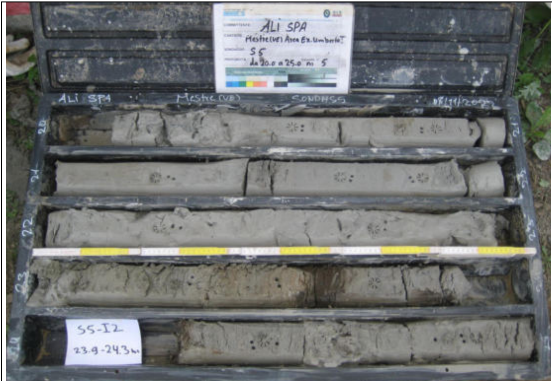
Sondaggio Geognostico S5 - Contenuto cassetta catalogatrice (20,00 – 25,00 m)
