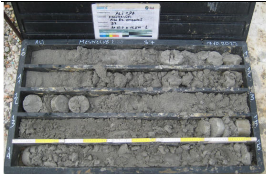
Sondaggio Geognostico S7 - Contenuto cassetta catalogatrice (10,00 – 15,00 m)
