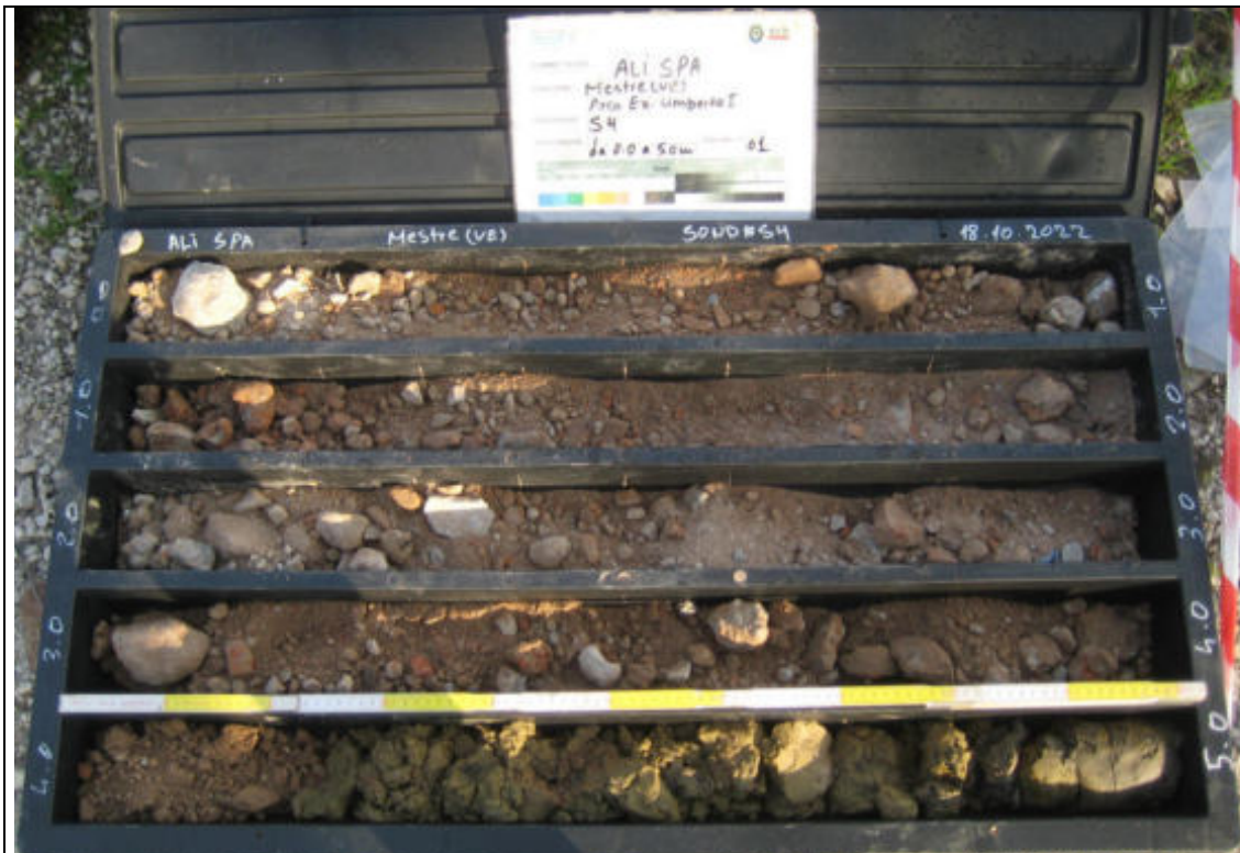
Sondaggio Geognostico S4 - Contenuto cassetta catalogatrice (0,00 – 5,00 m)
