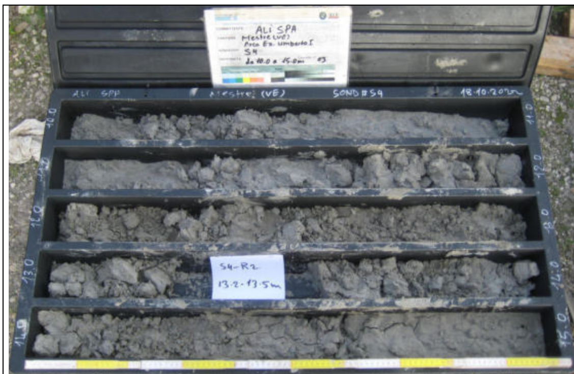
Sondaggio Geognostico S4 - Contenuto cassetta catalogatrice (10,00 – 15,00 m)
