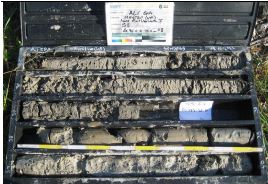
Sondaggio Geognostico S9 - Contenuto cassetta catalogatrice (35,00 – 40,00 m)
