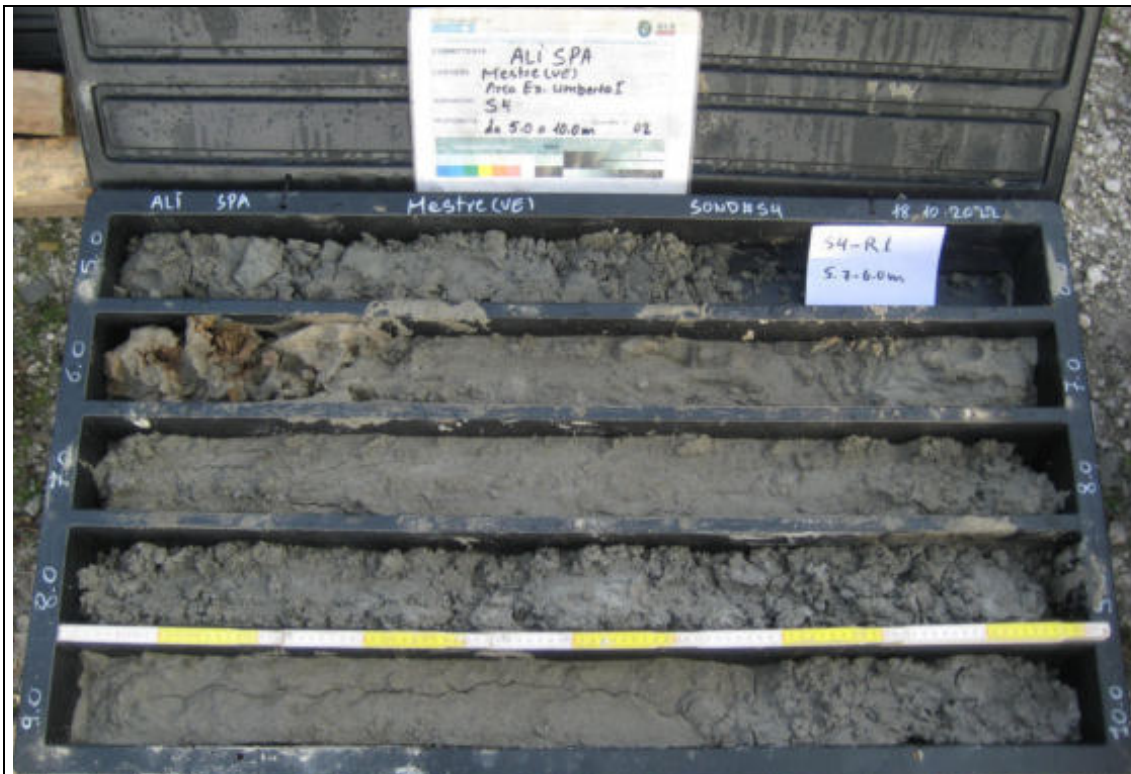
Sondaggio Geognostico S4 - Contenuto cassetta catalogatrice (5,00 – 10,00 m)
