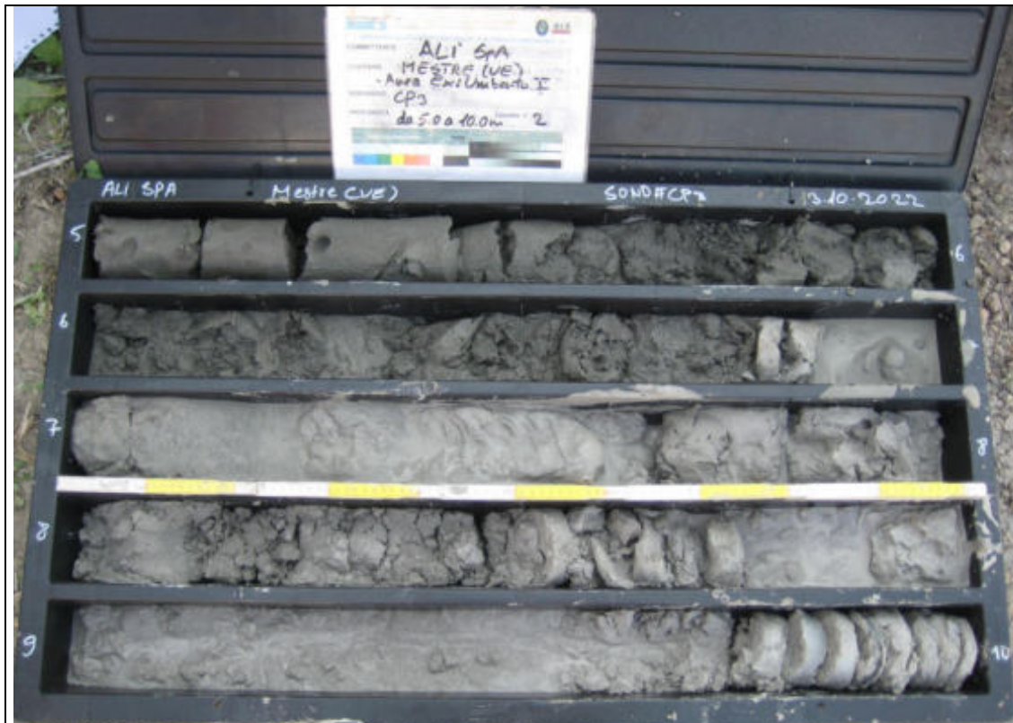
Sondaggio Geognostico S5 - Contenuto cassetta catalogatrice (5,00 – 10,00 m)
