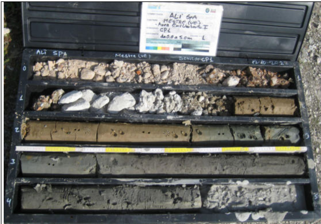
Sondaggio Geognostico S1 - Contenuto cassetta catalogatrice (0,00 – 5,00 m)
