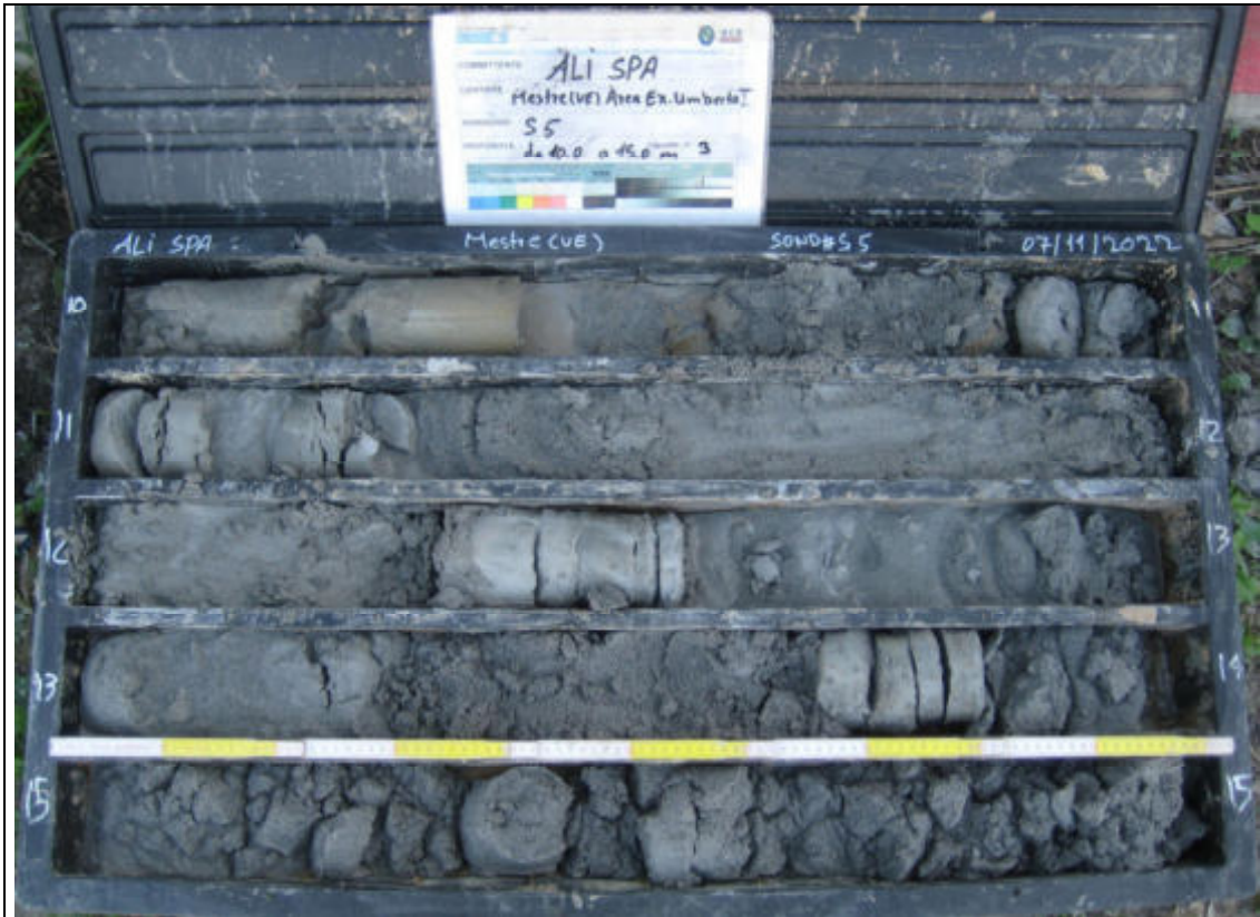
Sondaggio Geognostico S5 - Contenuto cassetta catalogatrice (10,00 – 15,00 m)
