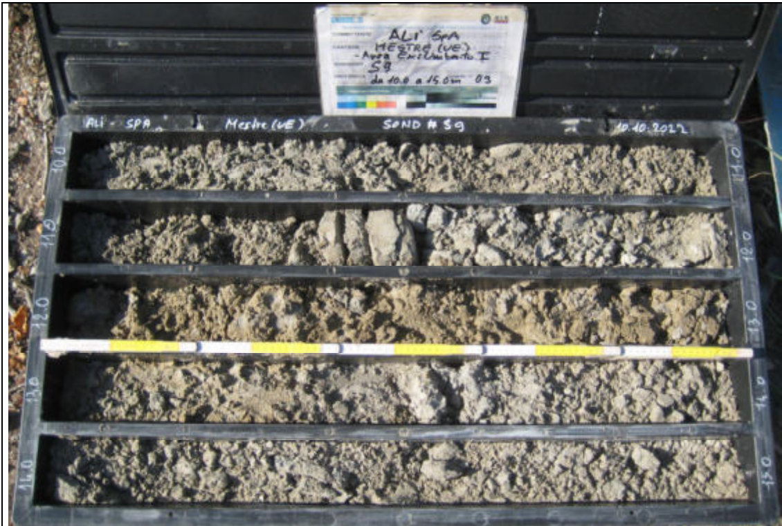
Sondaggio Geognostico S9 - Contenuto cassetta catalogatrice (10,00 – 15,00 m)
