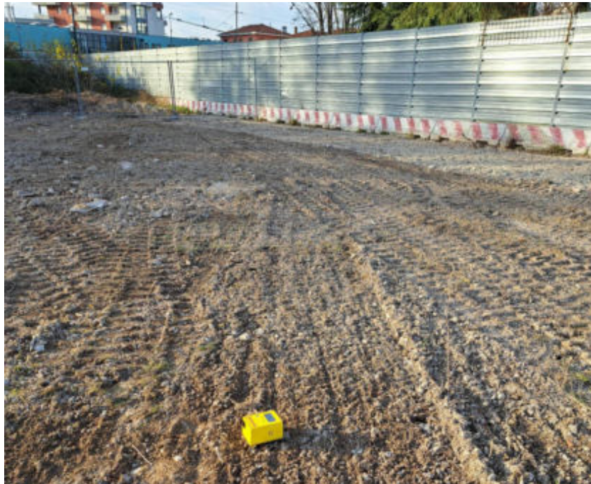
Foto 15: Esecuzione della prova sismica HVSR -Tromino1
