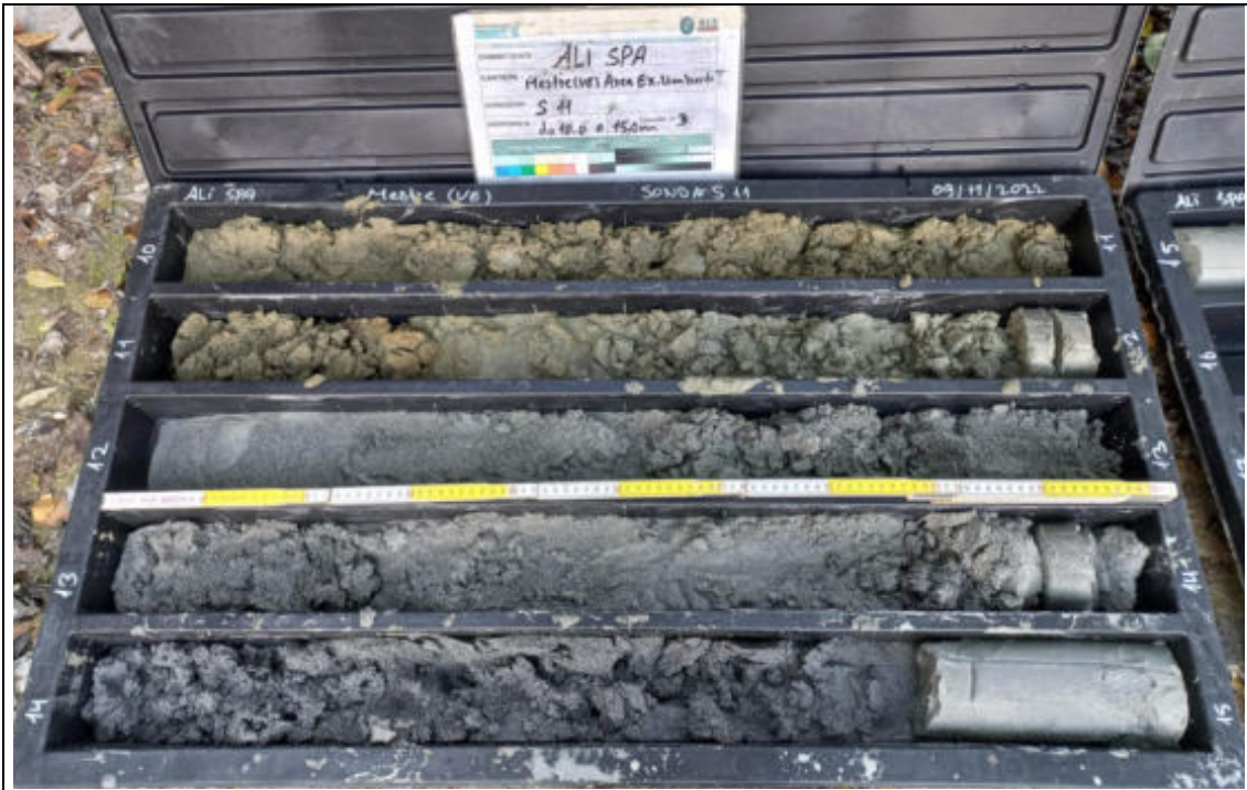
Sondaggio Geognostico S11 - Contenuto cassetta catalogatrice (10,00 – 15,00 m)
