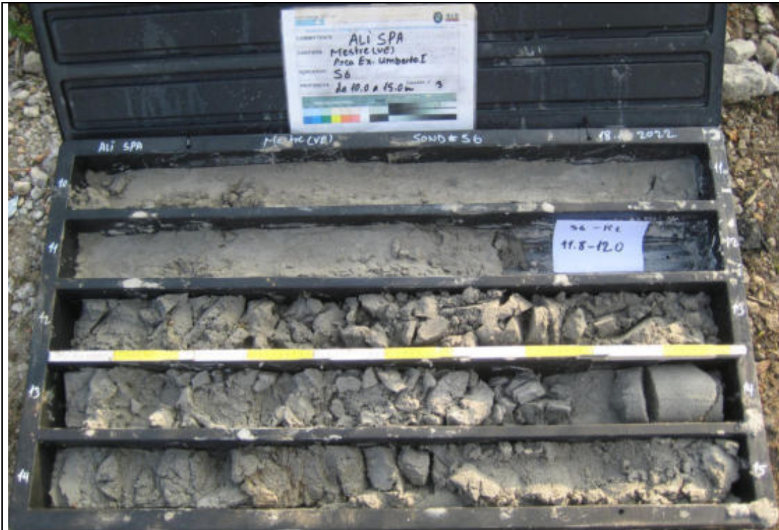
Sondaggio Geognostico S6 - Contenuto cassetta catalogatrice (10,00 – 15,00 m)
