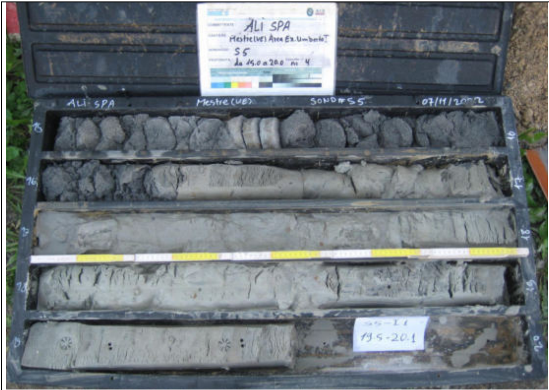
Sondaggio Geognostico S5 - Contenuto cassetta catalogatrice (15,00 – 20,00 m)
