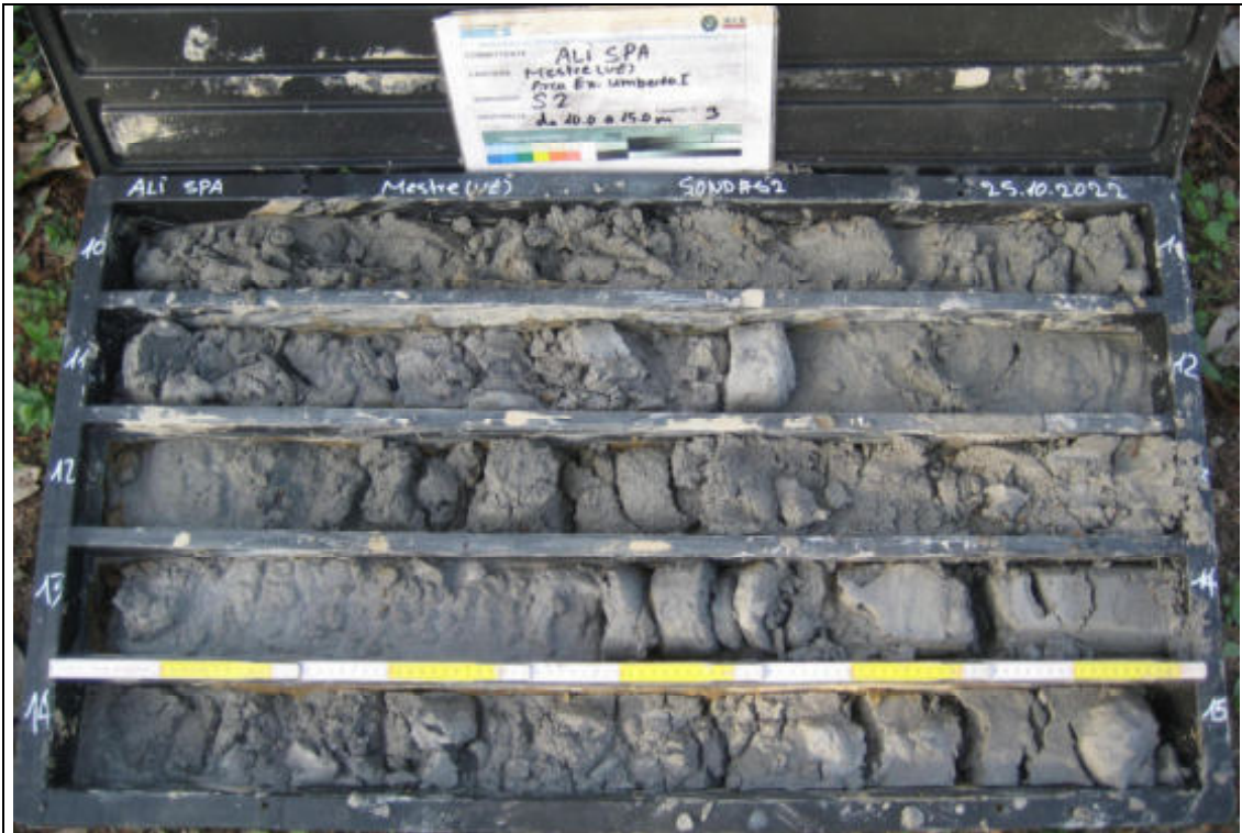
Sondaggio Geognostico S2 - Contenuto cassetta catalogatrice (10,00 – 15,00 m)
