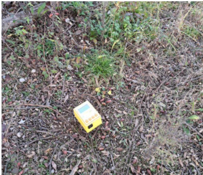
Foto 16: Esecuzione della prova sismica HVSR -Tromino2
