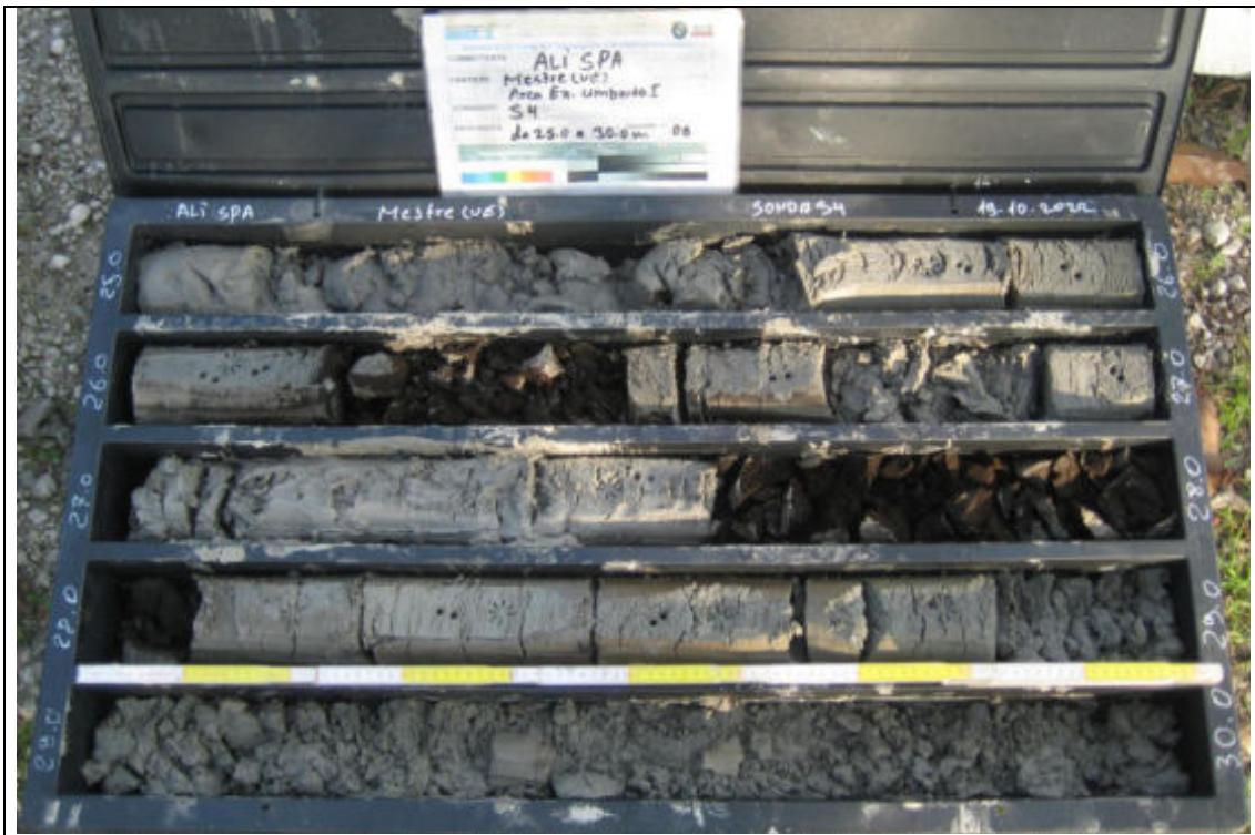
Sondaggio Geognostico S4 - Contenuto cassetta catalogatrice (25,00 – 30,00 m)
