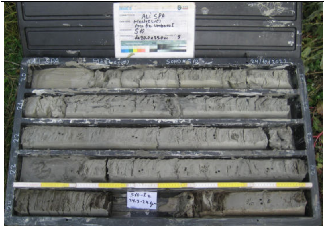
Sondaggio Geognostico S10 - Contenuto cassetta catalogatrice (20,00 – 25,00 m)
