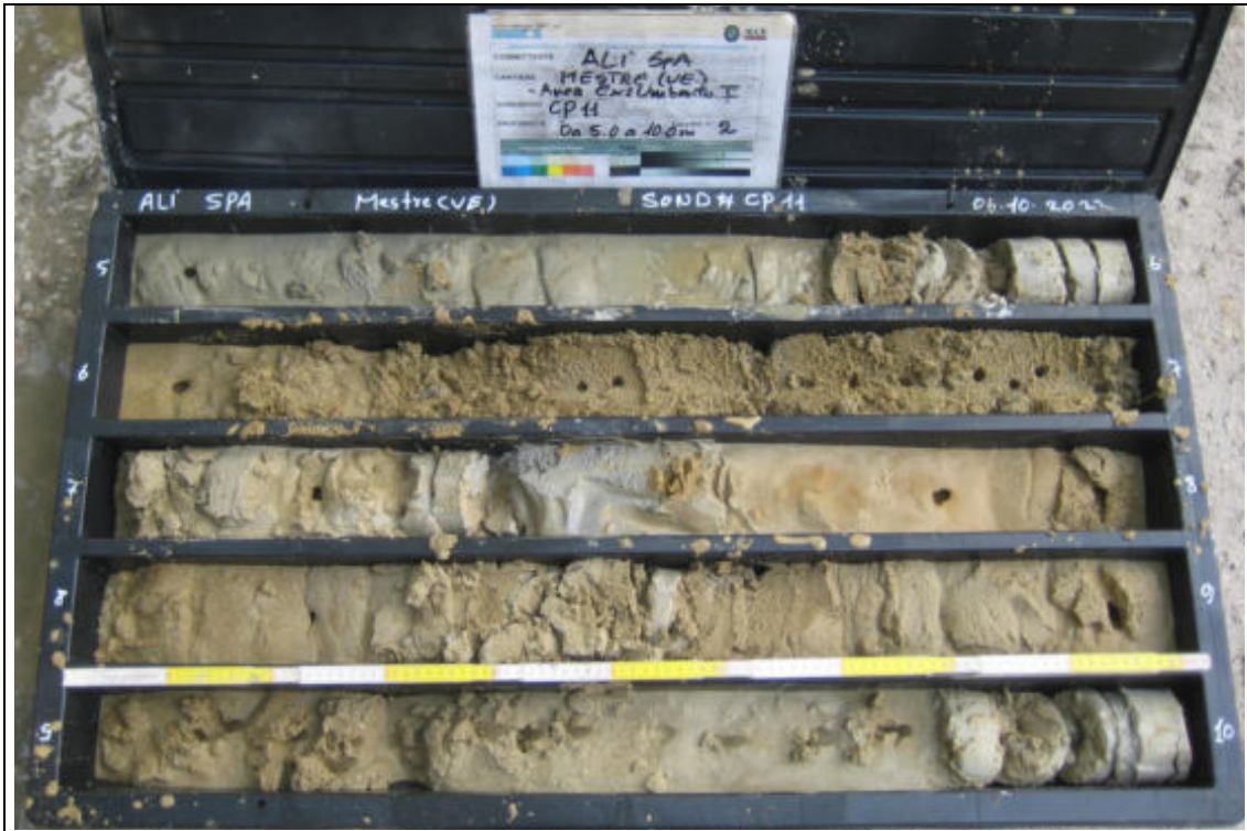
Sondaggio Geognostico S11 - Contenuto cassetta catalogatrice (5,00 – 10,00 m)
