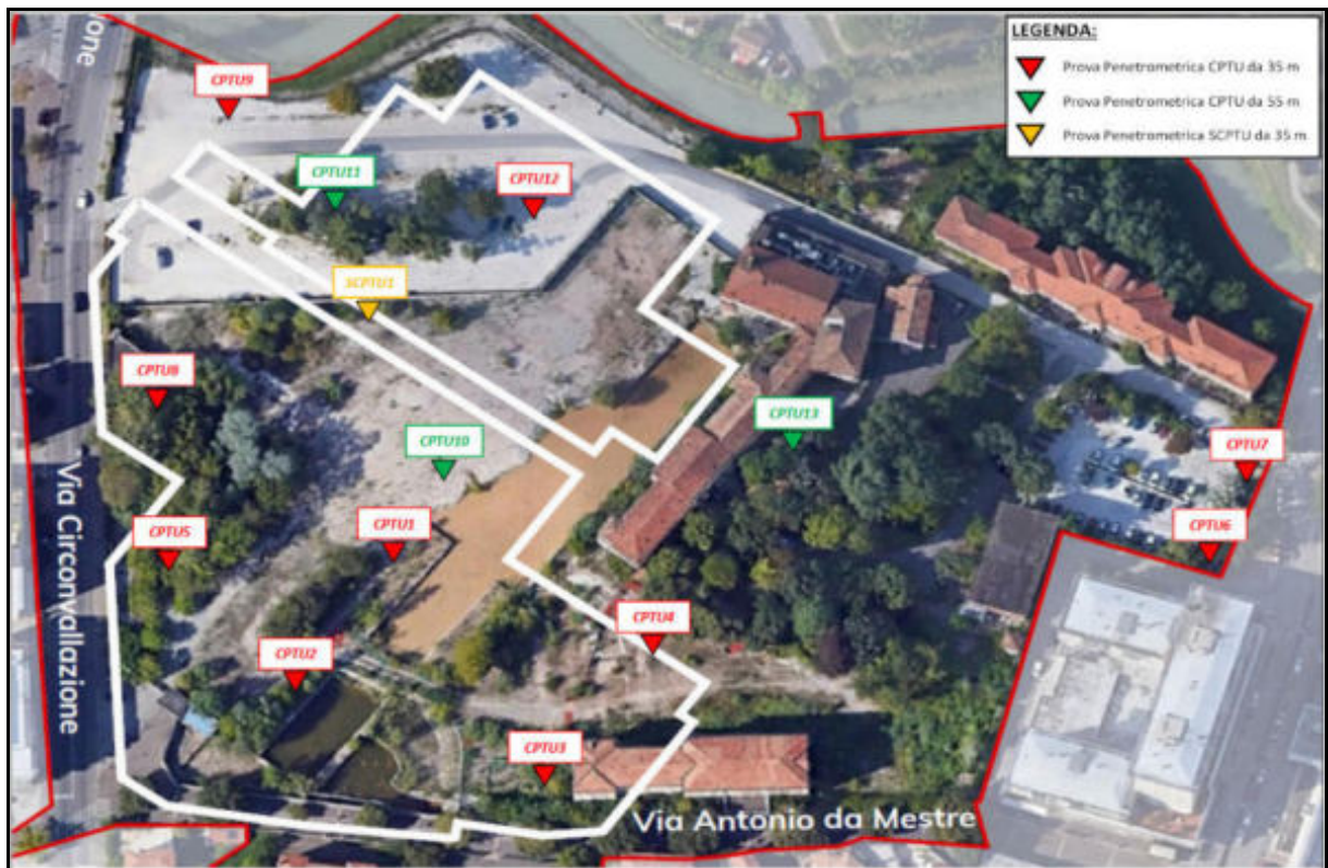
Planimetria non in scala con ubicazione Prove Penetrometriche Statiche con Piezocono (CPTU) e Piezocono Sismico (SCPTU)
