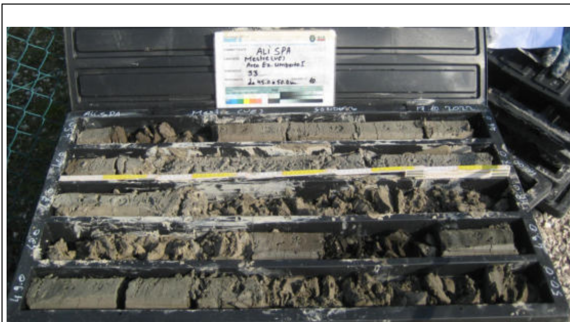
Sondaggio Geognostico S3 - Contenuto cassetta catalogatrice (45,00 – 50,00 m)
