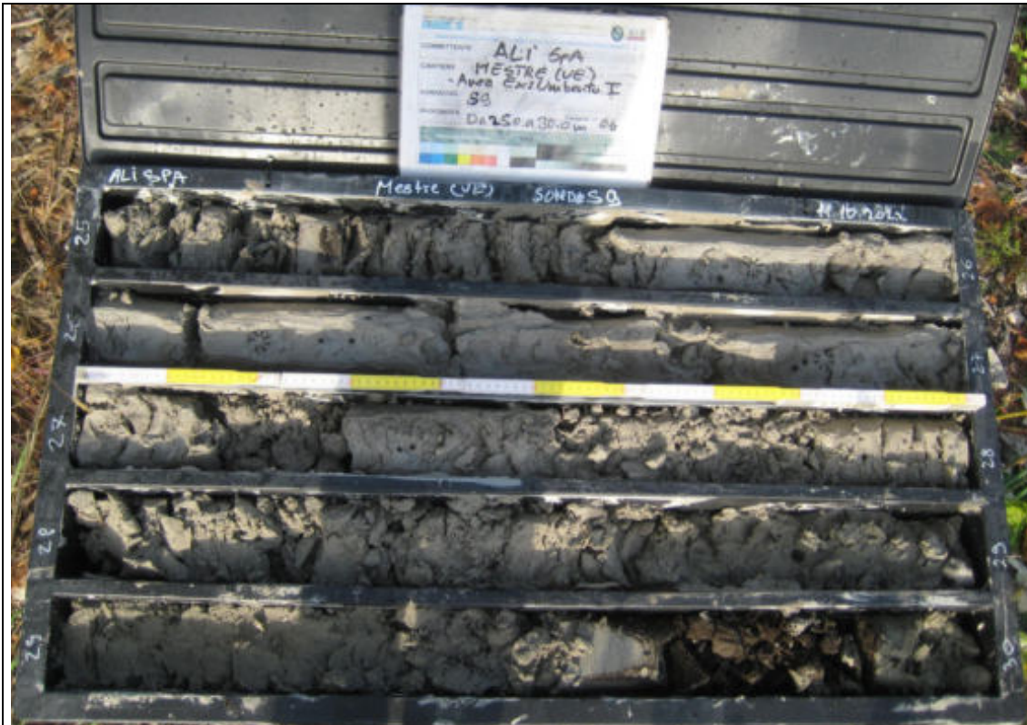
Sondaggio Geognostico S9 - Contenuto cassetta catalogatrice (25,00 – 30,00 m)
