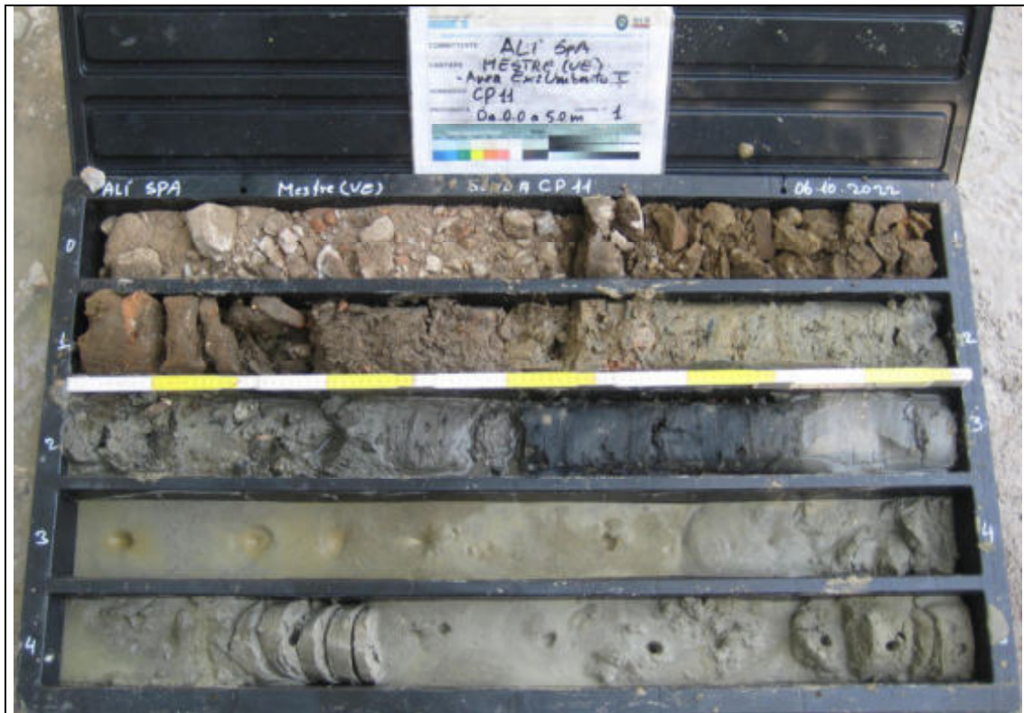
Sondaggio Geognostico S11 - Contenuto cassetta catalogatrice (0,00 – 5,00 m)
