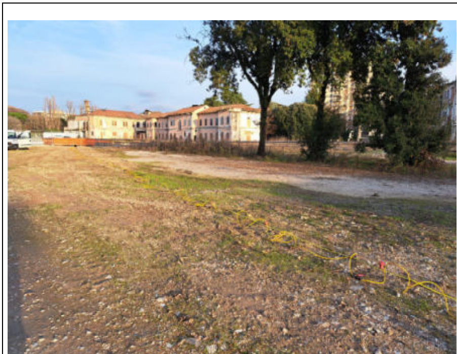
Foto 14: Esecuzione della prova sismica MASW
