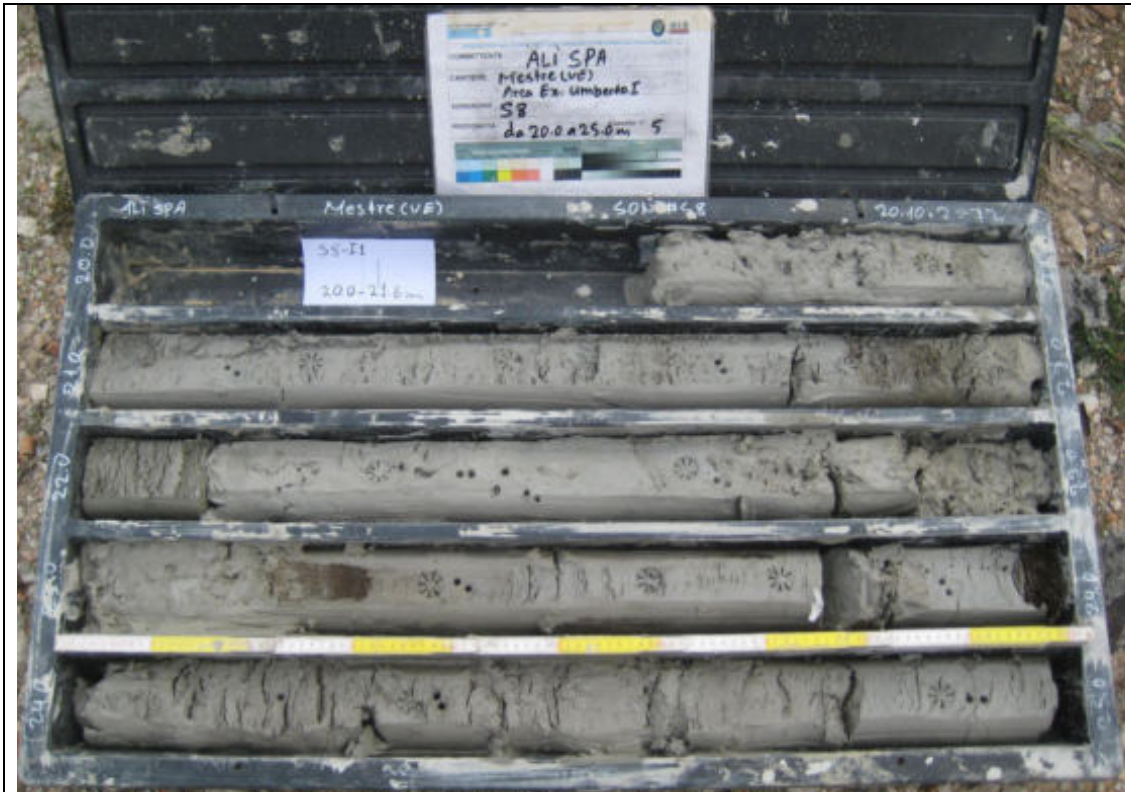
Sondaggio Geognostico S8 - Contenuto cassetta catalogatrice (20,00 – 25,00 m)
