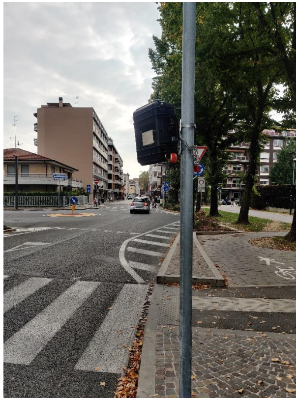
Figura 20: Dispositivo radar installato - via Filiasi
