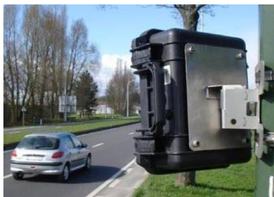
Figura 7: Esempio strumentazione radar Icoms TMS-SA4
