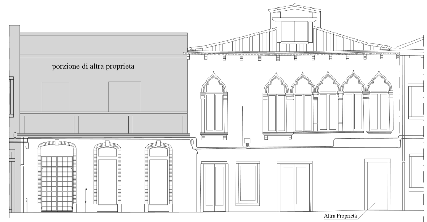
PROSPETTO FONDAMENTA NAVAGERO
